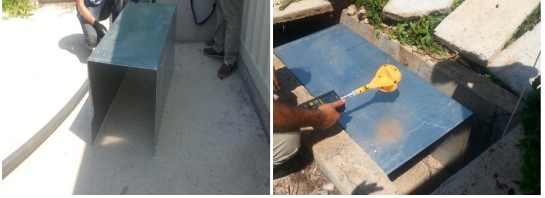
Şekil 3.14. Ters U Galvaniz Ekran ile YG Kanalda Ölçüm
