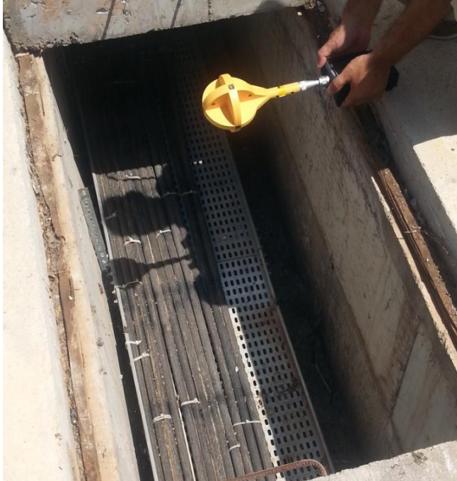
Şekil 3.15. AG Kanalda Ekransız Ölçüm
