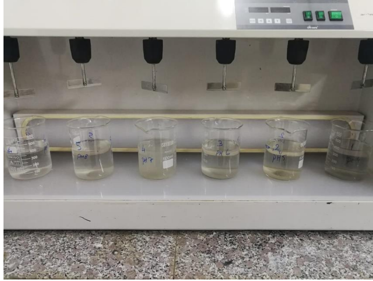
Şekil 4.4. Jar testi düzeneği arıtım çalışmaları örnekler.
