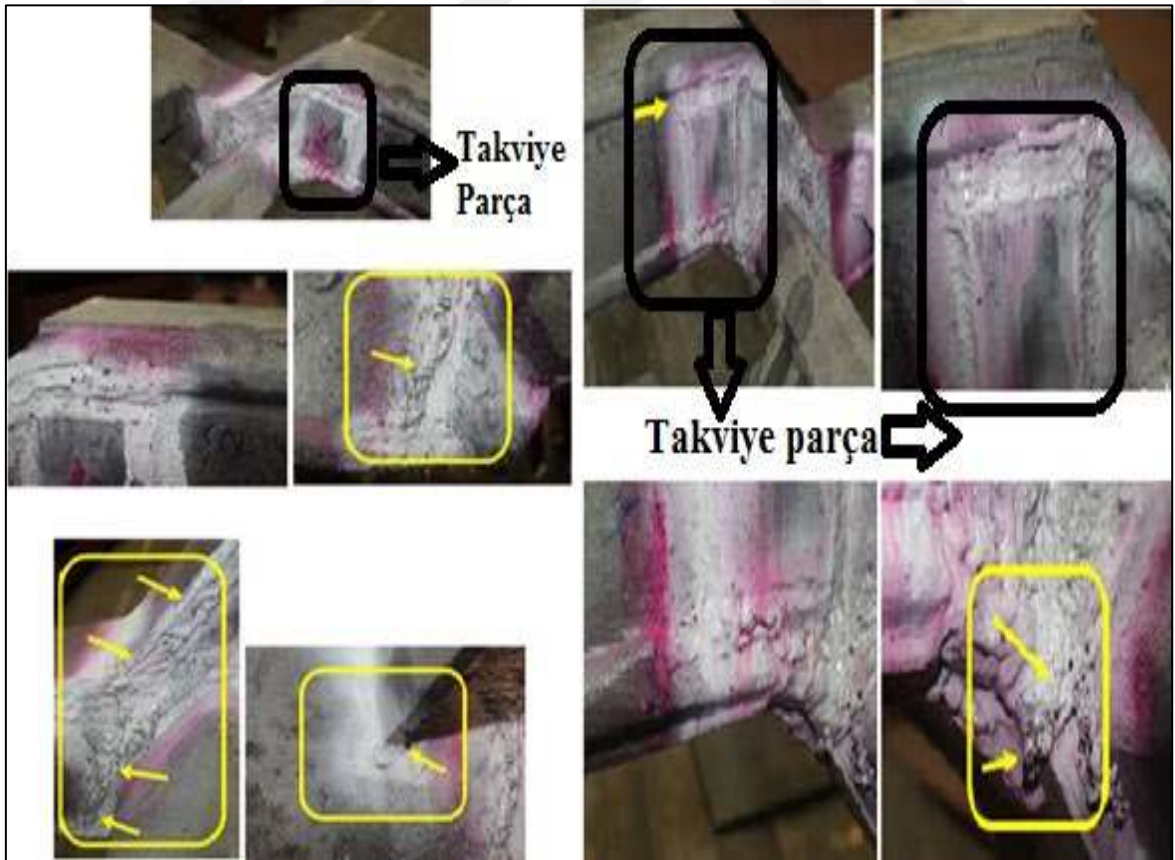
Şekil 78. Üst şasinin arka kısmında görülen hatalar
