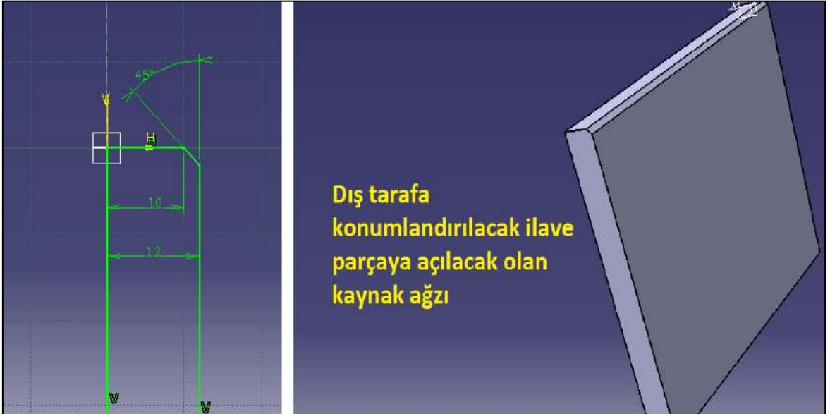
Şekil 73. Alt – üst saclar ile köşe kaynak birleşimi için dış tarafa konumlandırılan ilave parçaya açılan kaynak ağzının gösterimi
