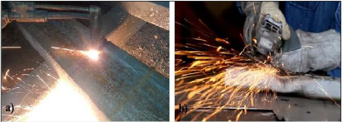
Şekil 58. a) Oksijenle kesme, b) Kesme taşıyla kesme
