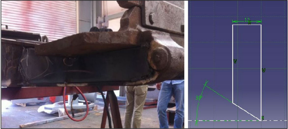
Şekil 69. Dış taraf web sacı kesilmiş ağza açılan kaynak ağzının gösterimi
