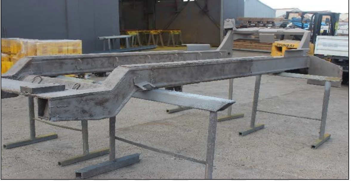
Şekil 39. Kumlama sonrası üst şasinin genel görünümü
