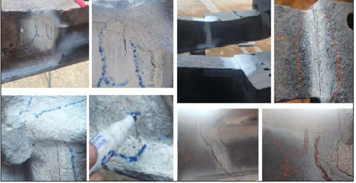
Şekil 83. Alt şasi ile üst şasi arasındaki kaldırma silindirlerinin bağlandığı, alt şasiye ait bölgedeki hatalar
