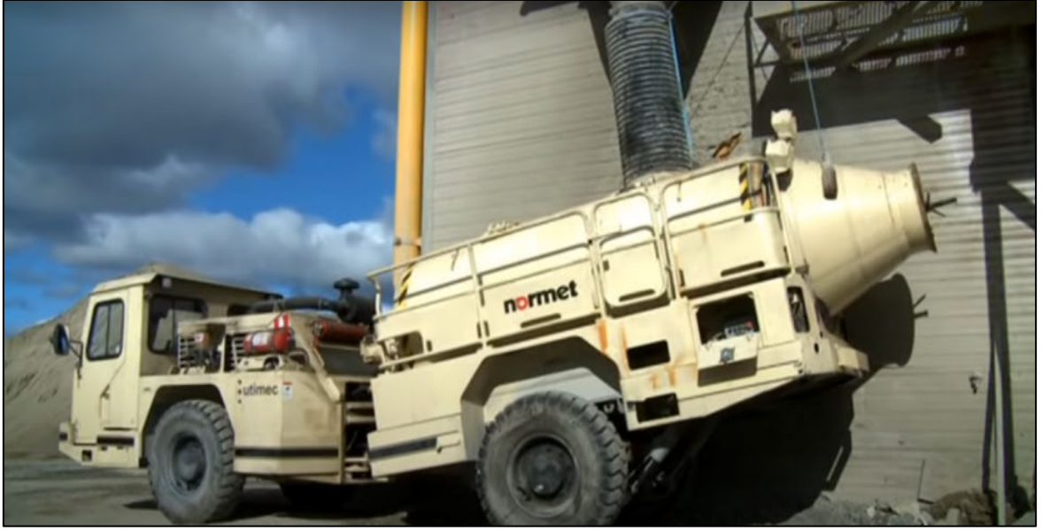
Şekil 31. Mikser kazanına beton doldurulması [12].
