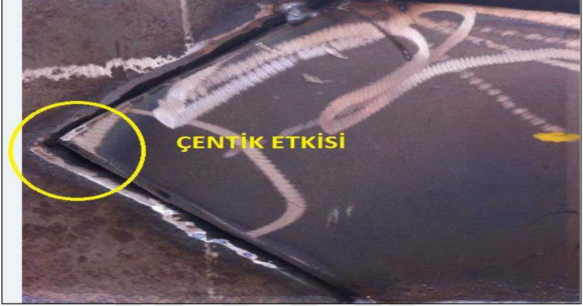
Şekil 66. Çentik etkisi oluşturabilecek tipik bir birleşim
