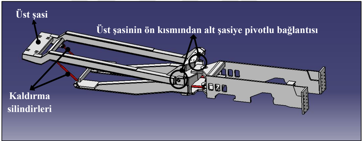
Şekil 85. Üst şasinin kaldırma silindirleri vasıtasıyla açılı olarak yükselmiş hali
