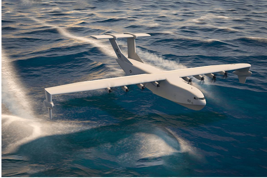
Şekil 5 Liberty Lifter yer etkili aracı tasarımı ( https://newatlas.com/military/darpas-liberty-lifter-x-plane-gets-a-face-lift/ )
