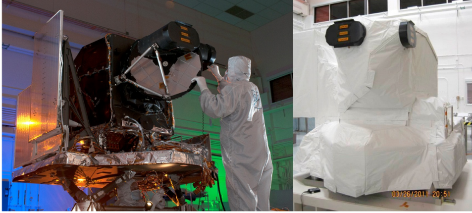
Şekil 2.8. LandSat-8 için çok katmanlı izolasyon uygulanırken
