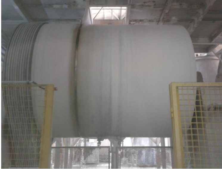
Şekil 4.5. Alumina Bilyalı Süreksiz Değirmen
