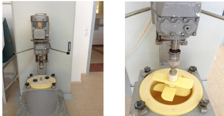
Şekil 4.3. Laboratuvar Tipi Atritör Değirmeni
