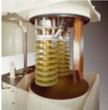
Şekil 5.27. Atritör değirmende kullanılan karıştırıcı tipleri (A) DISK, (B) PIN
