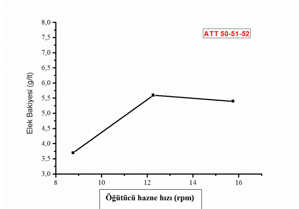
Şekil 5.47. Öğütücü hazne dönme hızının sır elek bakiyesine etkisi
