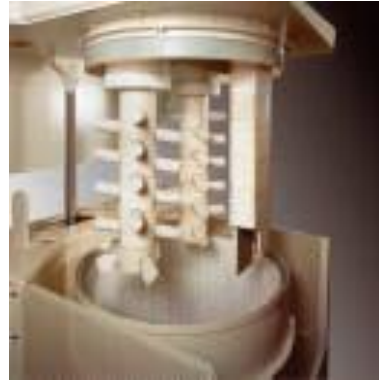
Şekil 5.27. Atritör değirmende kullanılan karıştırıcı tipleri (A) DISK, (B) PIN
