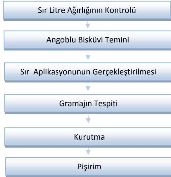
Şekil 4.7. Sır Uygulama Süreci İş Akışı
