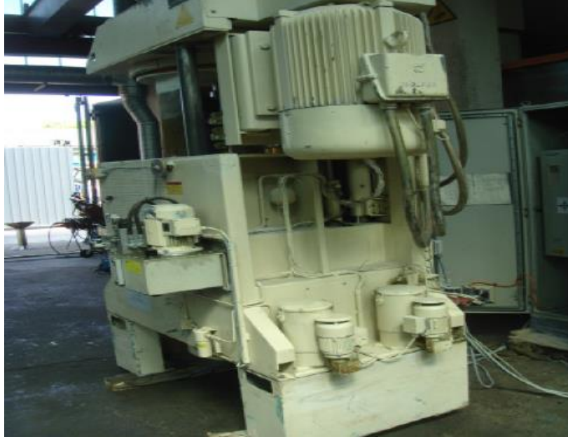
Şekil 5.26. Endüstriyel atritör değirmen (Expert Makine, 2013)
