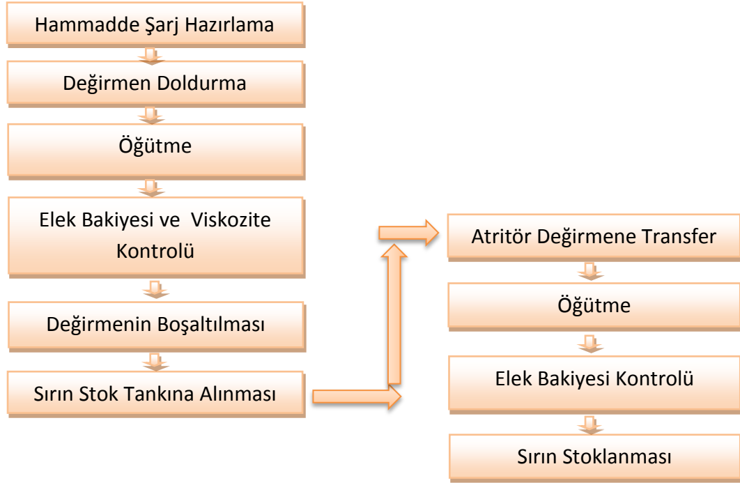
Şekil 4.2. Sır Hazırlama Süreci İş Akışı
