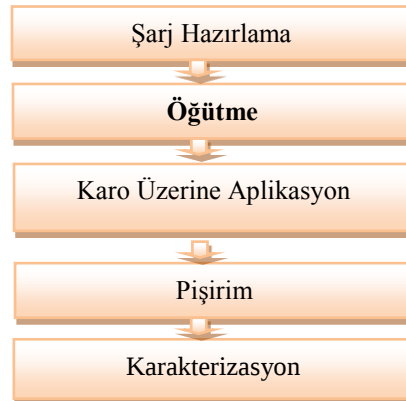
Şekil 2.2. Sır Üretim ve Uygulama Süreci
