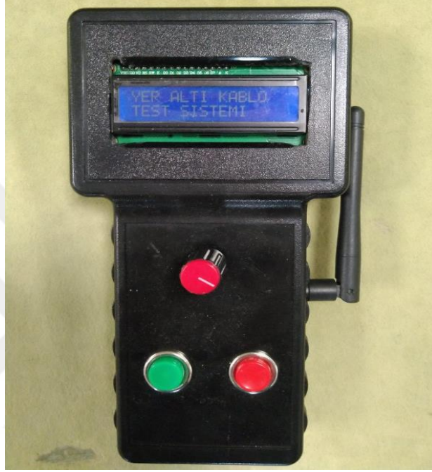
Şekil 3.24 Darbe jeneratörünün kontrol kumandasının görüntüsü.
