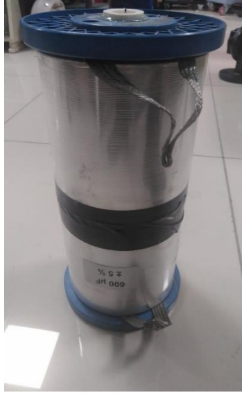
Şekil 3.13 Darbe jeneratörünün yüksek gerilim kondansatörü.
