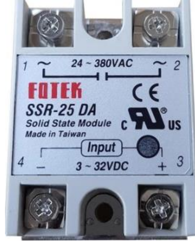
Şekil 3.20 Aç kapa özelliği için kullanılan elektronik röle
