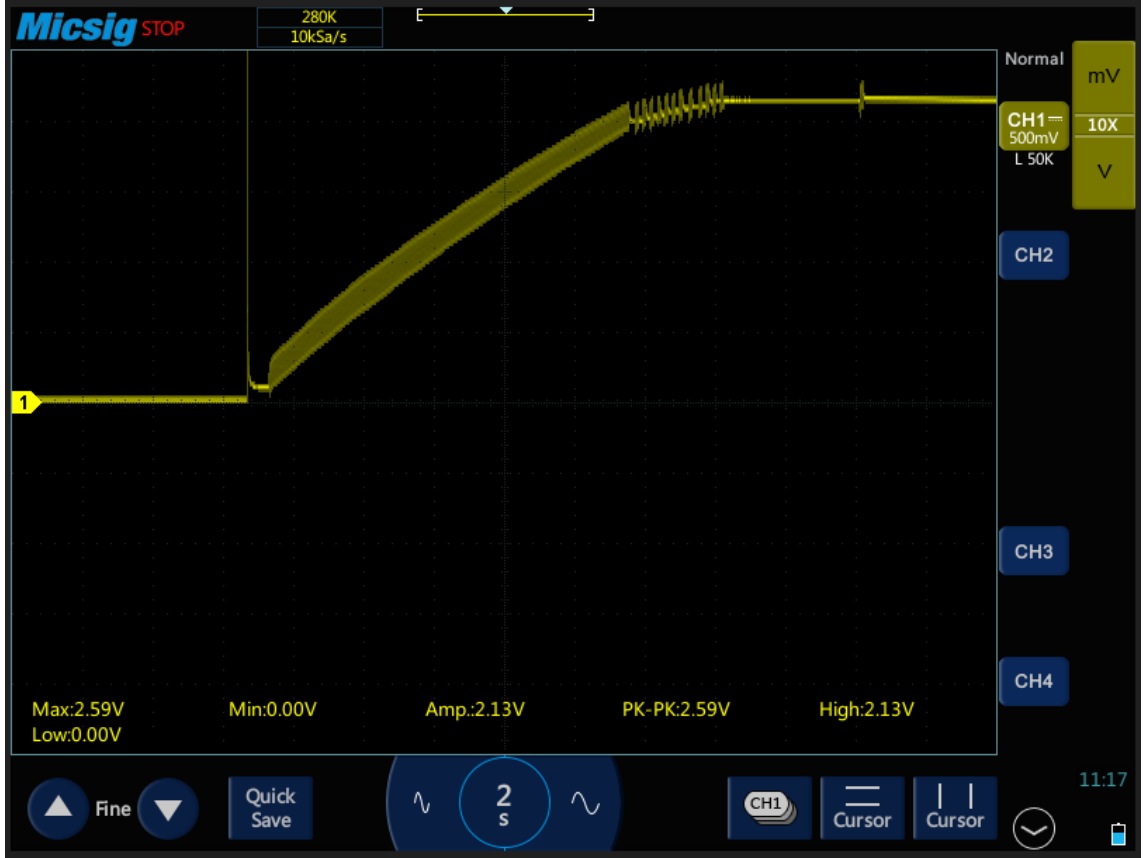
Şekil 4.7 İstenilen gerilim değeri 2500V, şarjlanan gerilim yaklaşık 2250V.
