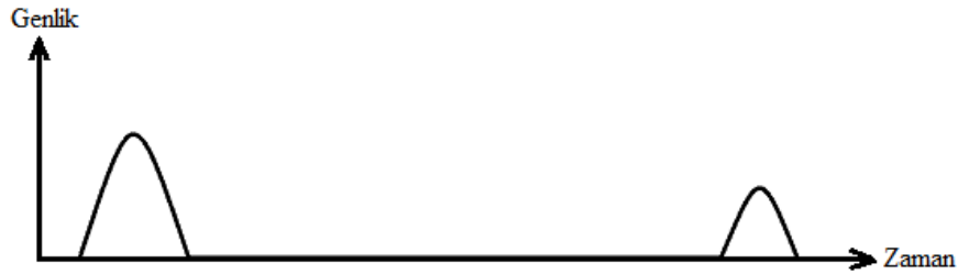
Şekil 2.11 Seri arızada yansıyan dalga.
