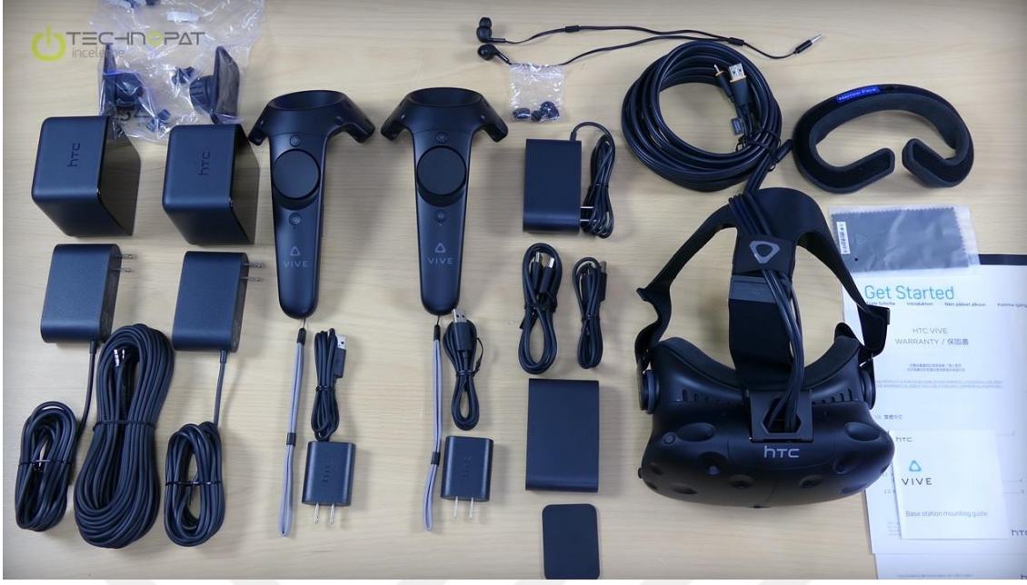
Resim 5.2 HTC Vive'in tüm parçaları (İnt.Kyn.34).
