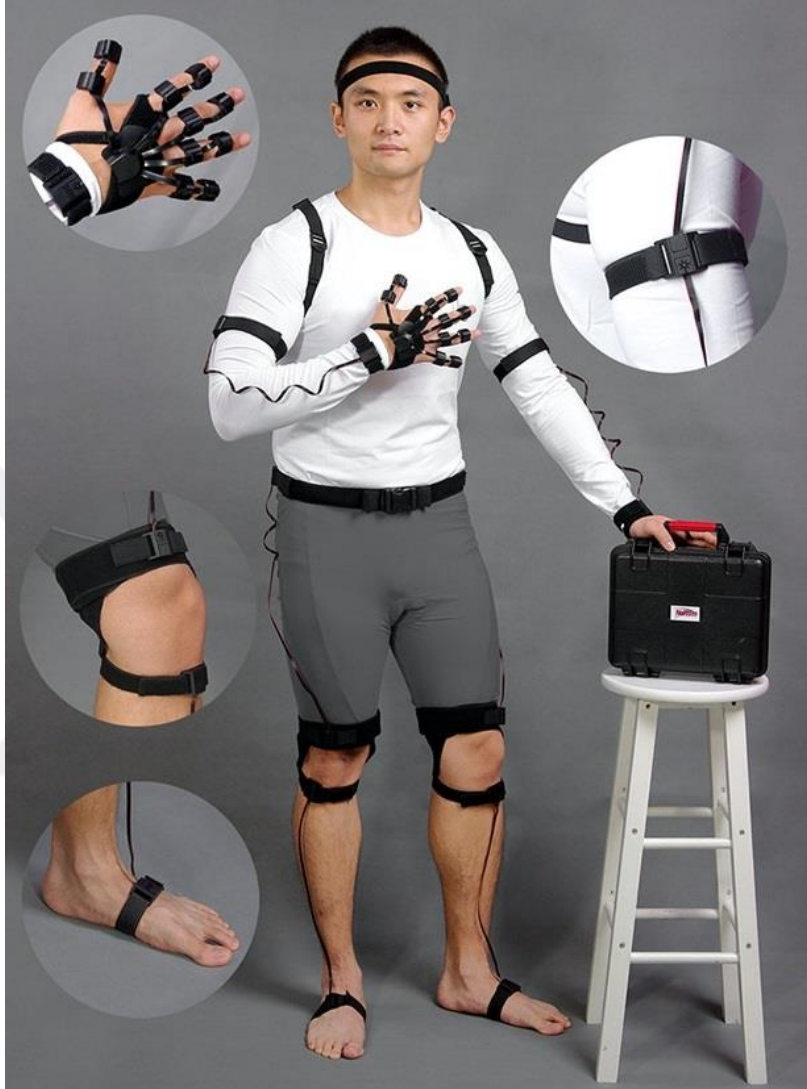
Resim 3.6 Nöron algılayıcı sistem ekipmanı (İnt.Kyn.6).
