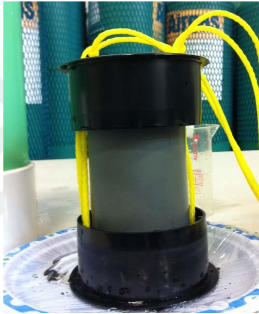
Şekil 9. ASTM C 1308-08'e göre macun dolgunun su kalitesine etkisinin değerlendirilmesi (Moran vd., 2013)
