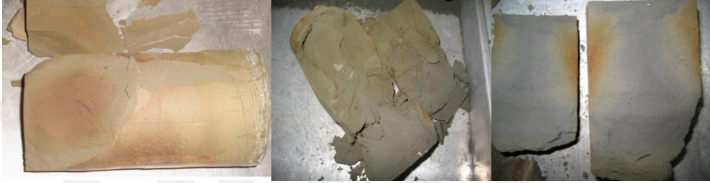
Şekil 2. Çimentolu macun dolguda 360 günlük kür süresinde oksidasyonun numunenin iç kısımlarına ilerlemesi (Erçikdi vd., 2010, Cihangir vd. 2012)
