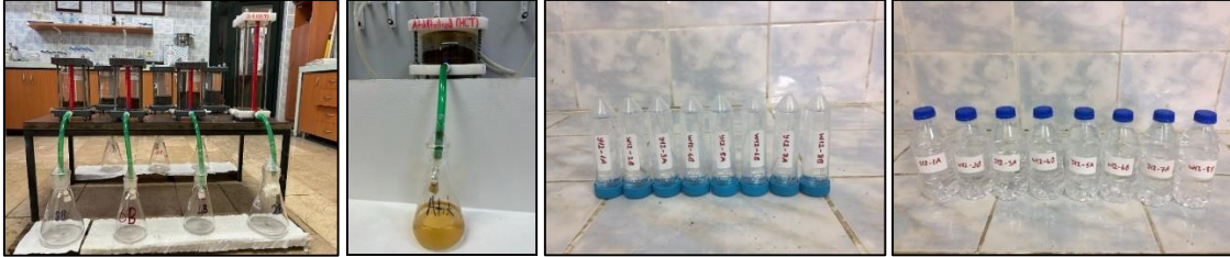
Şekil 16. Gerçekleştirilen kinetik nem hücresi testi (41 haftalık)
