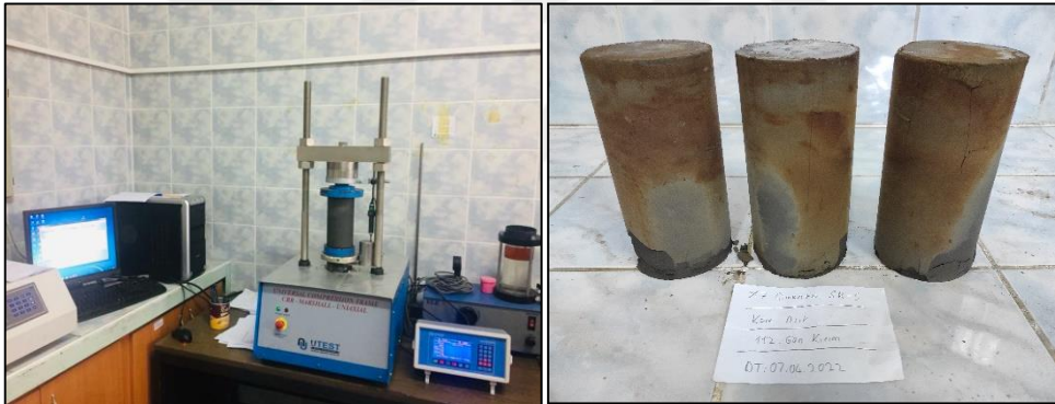
Şekil 14. Tek eksenli dayanım testlerinin (UCS) gerçekleştirilmesi
