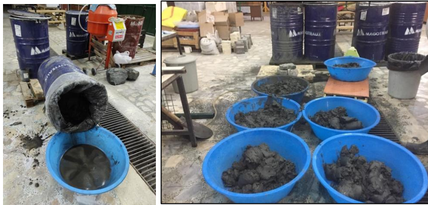
Şekil 11. Atık malzemelerin varillerden boşaltılması ve homojenleştirilmesi
