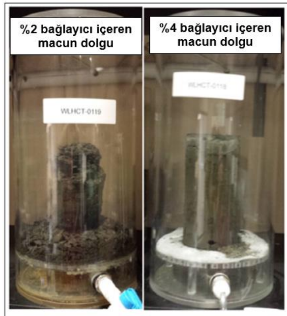
Şekil 10. Standart nem hücreli kinetik teste tabi tutulan %2 ve %4 bağlayıcı içeren macun dolgu numunelerinin 11 hafta sonundaki ayrışma görüntüleri (Seipel vd., 2017)
