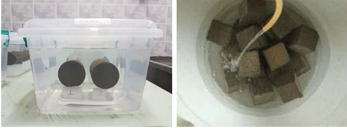
Şekil 7. Çimentolu macun dolgunun yeraltı sularına etkisine yönelik deneysel çalışma (Jiano vd., 2011, Yılmaz vd., 2021)
