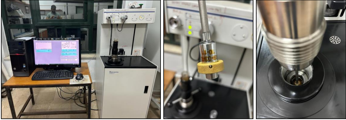
Şekil 15. MIP cihazı poroziteli yapı analizi
