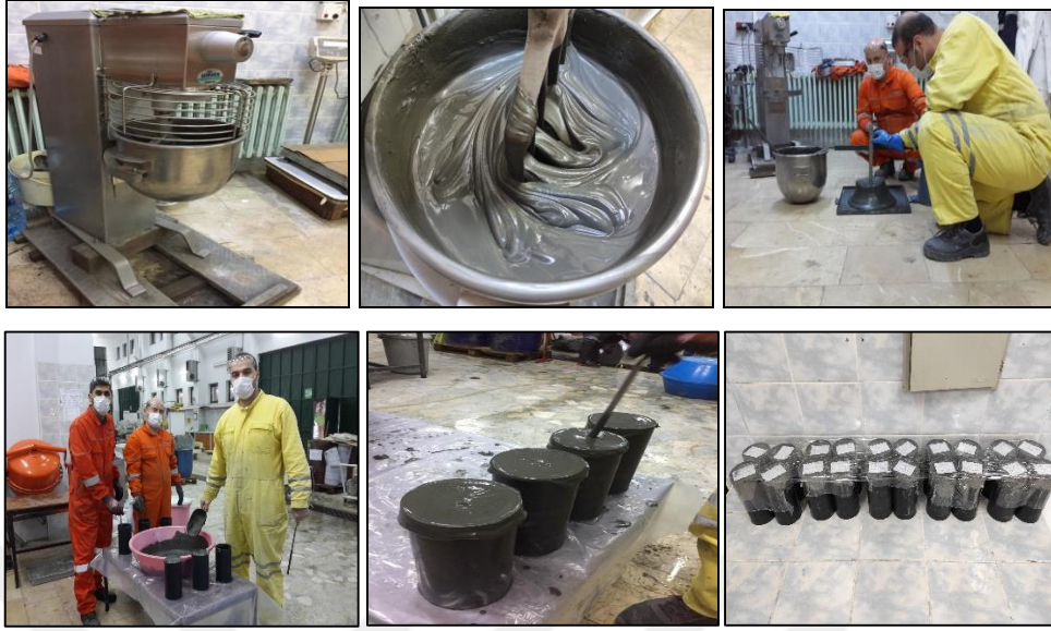
Şekil 13. Macun dolgu numunelerinin hazırlanması
