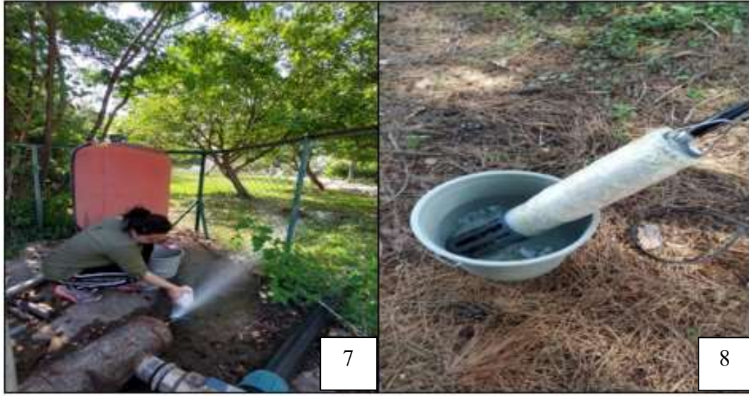
Şekil 3.10. Çok parametrelili sondanın kullanımı (Orijinal)
