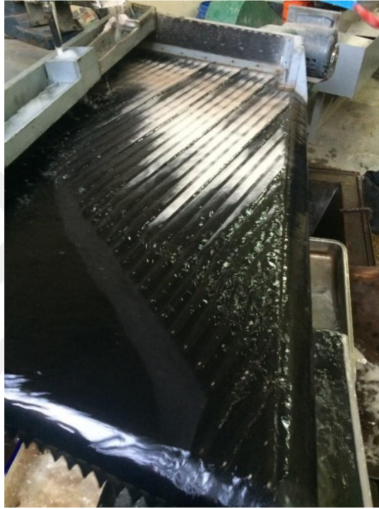
Şekil 7.16. Sallantılı masa (Masa_B) deneyine ait laboratuvar çalışması
