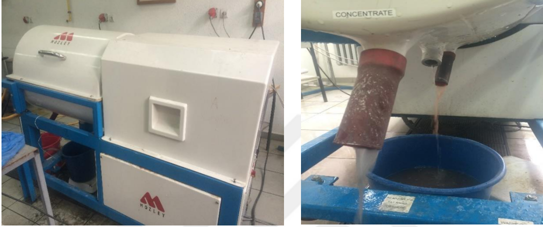
Şekil 7.48. MGS ekipmanı ile yapılan deneysel çalışmalara ait görüntüler
