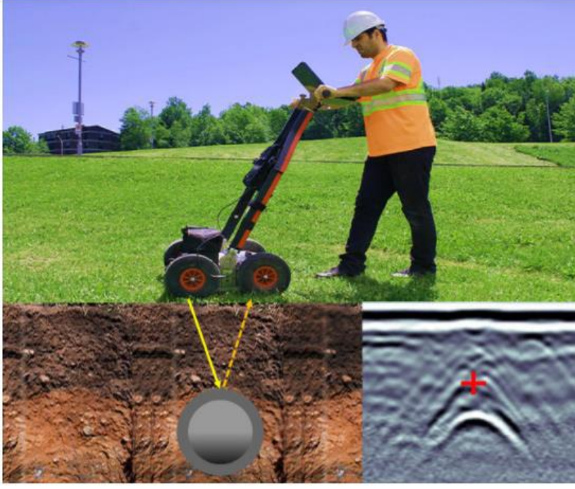
Şekil 1 Yere nüfuz eden radar işleyiş şeması
