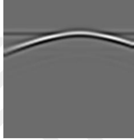
(b) Toprağa gömülmüş 1cm çapındaki telin gprmax programı ile B-tarama EM yayılım benzetimi (ön işlem görmüş)
