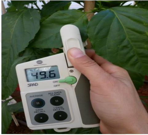
Şekil 3.5. SPAD-metre ile ölçüm yapımı
