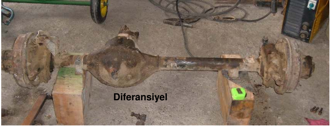
Şekil 2.12. Hurdadan alınmış diferansiyelli ön dingil
