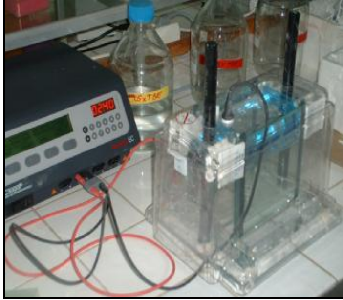
Şekil 3.11. Poliagrilamit Jelde DNA'nın Koşulması
