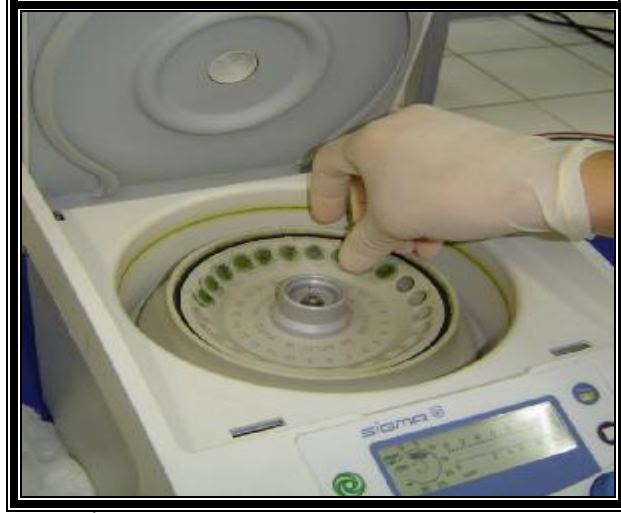
Şekil 3.5. Örneklerin İki Faza Ayrılmasını Sağlamak Amaçlı Santrifüj Aşaması
