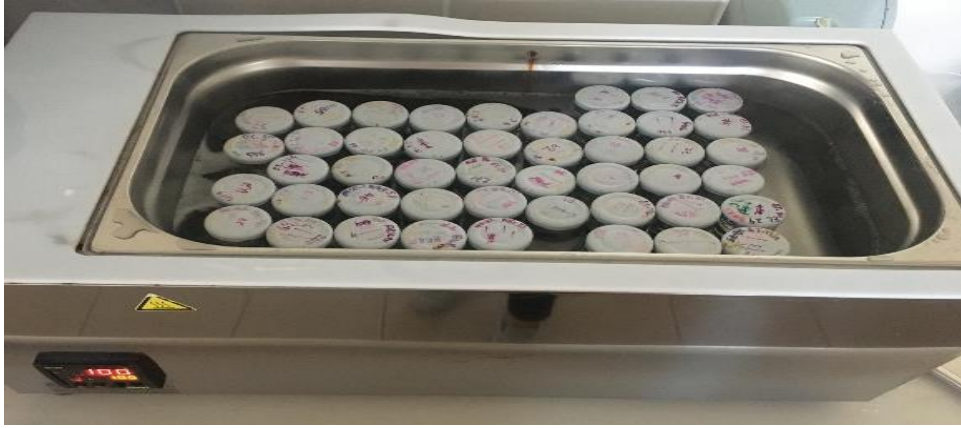
Şekil 3.11. Örneklerin 100 °C sıcak su banyosunda 30 dakika boyunca inkübasyonu
