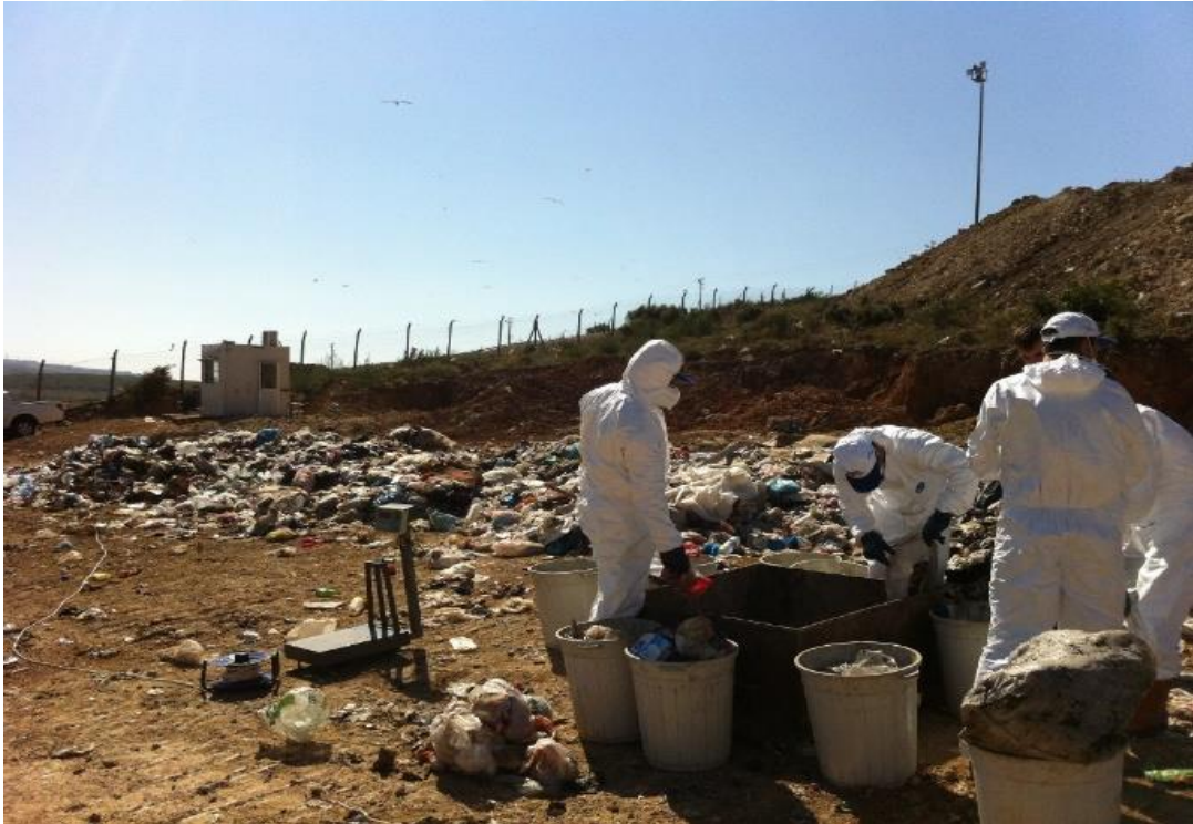
Şekil 3.4. Evsel atık karakterizasyon çalışması
