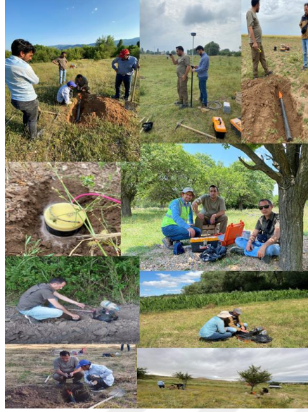
Resim 5.3 MT istasyonu kurulum aşamaları.
