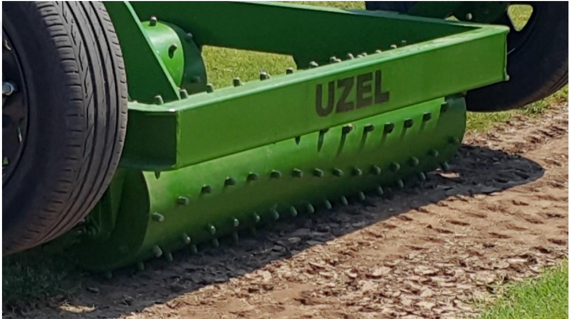
Şekil 3.5. Yaklaşık 450 kg ağırlığındaki Brinkman Trafik Simulatörünün yakından görünüşü.
