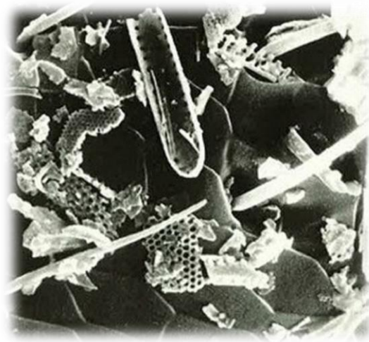
Şekil 3.2. Diaterra® toprağını oluşturan diatomitlerin elektron mikroskop görüntüleri (Anonim, 2021)
