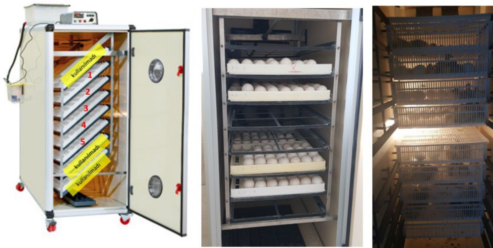
Şekil 3.18. Farklı Soğutma Suyu Sıcaklıkları Uygulaması; Solda ön gelişim makinası başlangıç yerleşim pozisyonu, ortada 10.gün yerleşim pozisyonu, sağda çıkış makinası yerleşim pozisyonu
