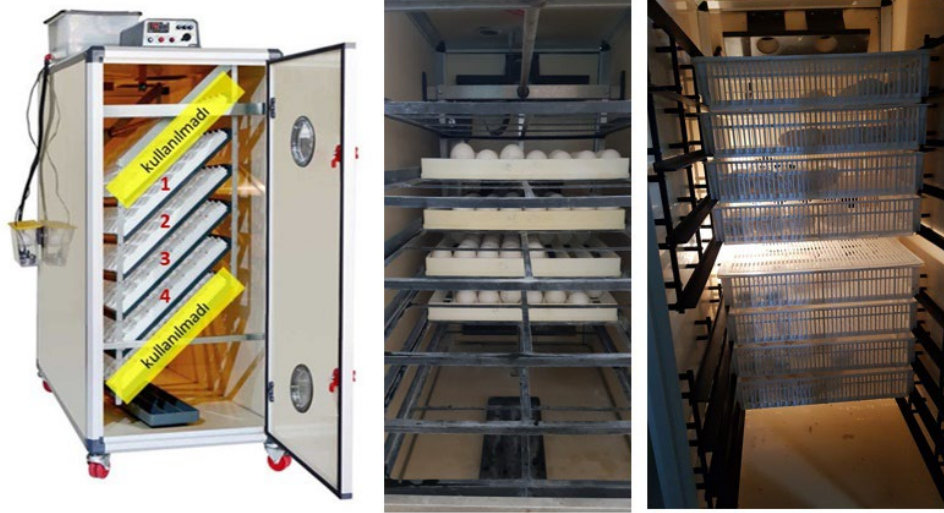
Şekil 3.15. Farklı soğutma yöntemleri uygulamasında; solda ön gelişim makinası başlangıç yerleşim pozisyonu, ortada 10.gün yerleşim pozisyonu, sağda çıkış makinası yerleşim pozisyonu
