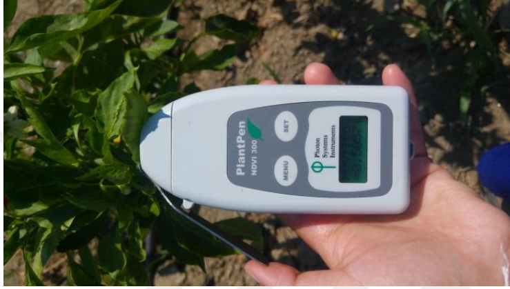
Şekil.3.6. (PlantPen NDVI 300) Klorofil ölçüm cihazı
