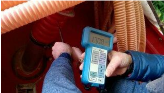
Şekil 3.14. Arařtırmada kullanılan kızgın telli anemometre
