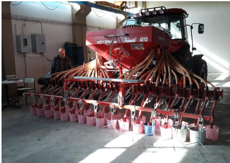
Şekil 3.16. Ayaklar arası dağılım düzgünlüğü ölçümleri
