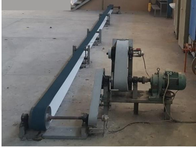
Şekil 3.15. Yapışkan bant deneme düzeni
