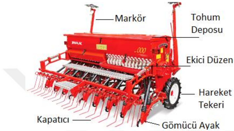
Şekil 1.3. Üniversal ekim makinasının parçaları (Anonim, 2019c)
