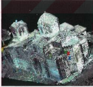
Şekil 5.8. Kaydedilmiş ve bütünleştirilmiş laser nokta kümesi
