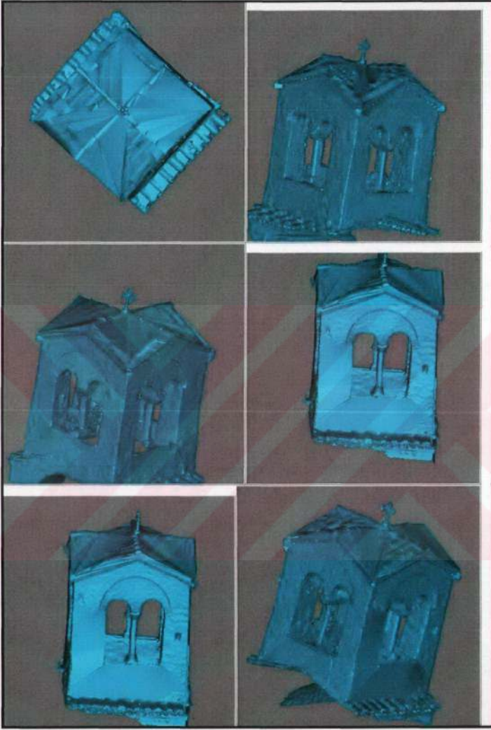
Şekil 7.38.Laser ve fotogrametrik modelin birlikte kullanımıyla boşlukları doldurulmuş model
