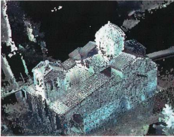
Şekil 5.5. Kaydedilmiş ve bütünleştirilmiş laser nokta kümesi
