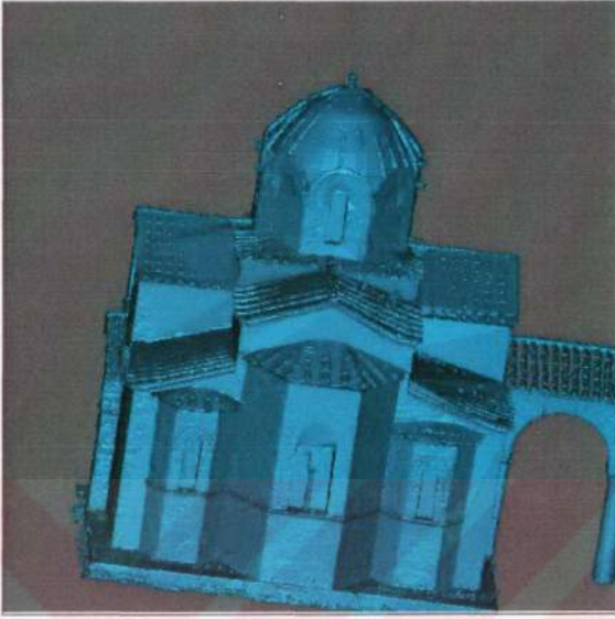
Şekil 7.22.İki Modelin üstüste çakıştırılmasıyla meydana gelen Bboşlukların giderilmesi.
