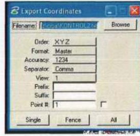
Şekil 7.25.dxf dosya biçimindeki modelin dışarıya nokta verisi olarak aktarımı.
