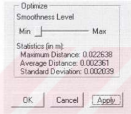
Şekil 4.2. Modelleme yazılımında nokta azaltma işlemi ve pürüzsüzlük derecesi ayarı
