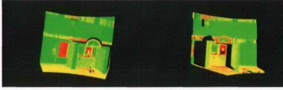
Şekil 4.3. Veri kaydı ve bütünleştirmeye tabi tutulmamış iki ayrı laser nokta kümesi
