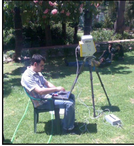
Şekil 8.35 Mensi GS 100 Lazer Tarayıcısının Kurulumu
