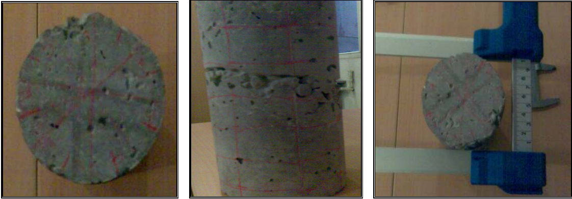
Şekil 8.83 Gerçek silindir model için oluşturulan kesitler ve çap uzunluğunun ölçülmesi işlemi
