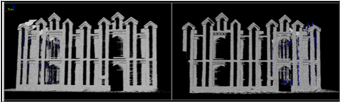
Şekil 8.5 Tarama alanındaki ortak (kesişen) yüzeyler
