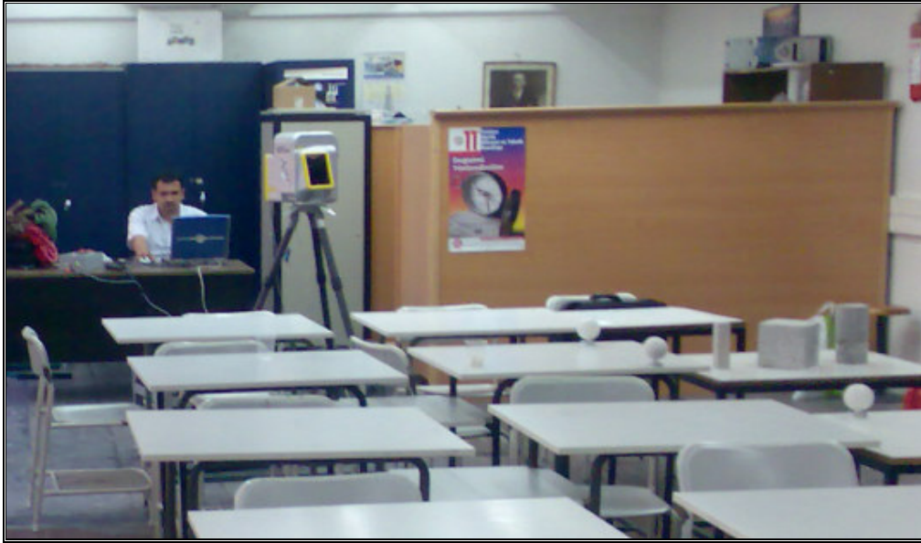
Şekil 8.59 Küre ve objelerin MENSİ GS 100 ile taranması
