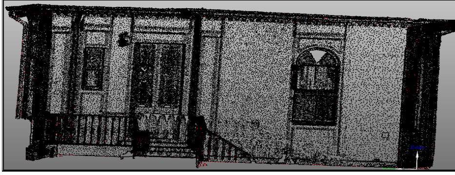
Şekil 8.54 Oluşan nokta bulutu görünümü
