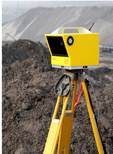
Şekil 1.2. Optech ve Riegl marka lazer tarama cihazı
