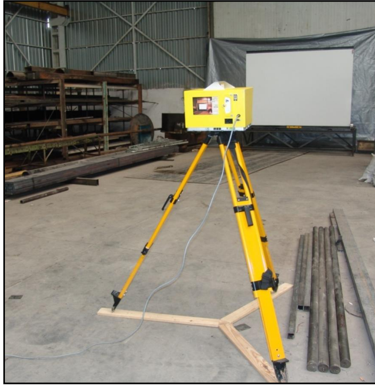
Şekil 3.3. Yapılan uygulamada kullanılan Optech Iris 3D yersel lazer tarayıcısı
