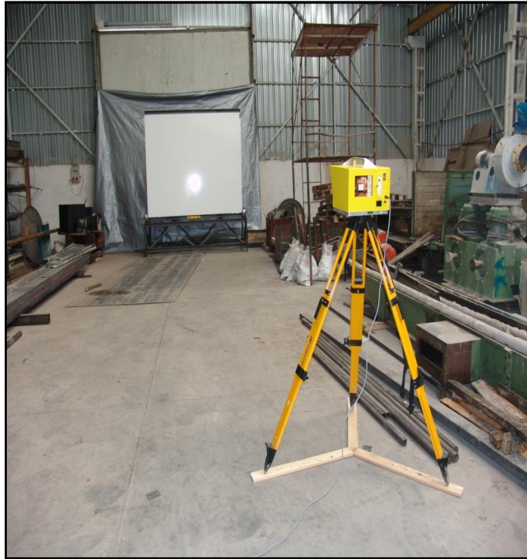
Şekil 3.11. Test alanının 20 metre mesafeden açılı taratılması
