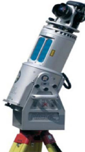
Şekil 1.2. Optech ve Riegl marka lazer tarama cihazı
