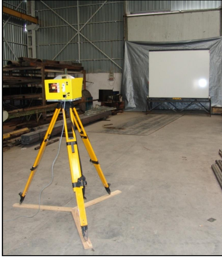
Şekil 3.10. Test alanının 10 metre mesafeden dik olarak taratılması
