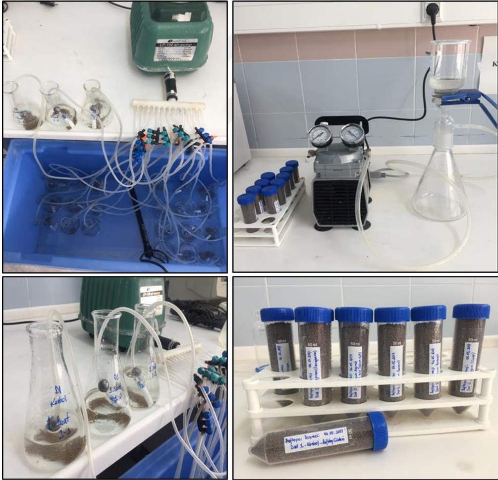
Şekil 4.12. Hidrostatilite testinde kullanılan düzenekler ve yem örnekleri.
