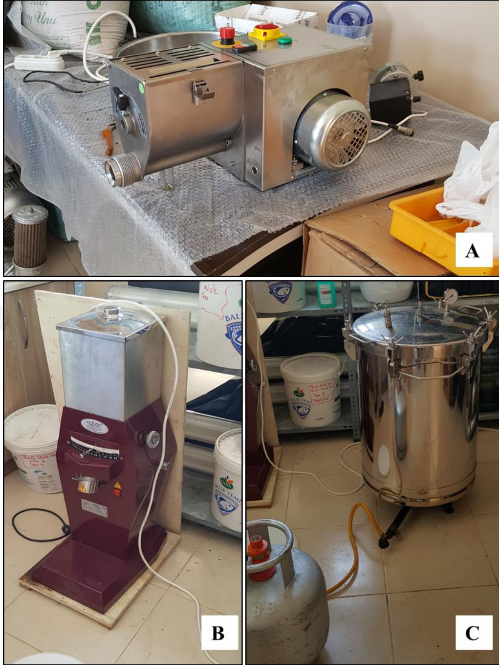
Şekil 4.4. Deneme yemlerinin preslendiği pelet makinası (A), hammaddelerin öğütüldüğü makina (B) ve peletlerin pişirildiği düzenek (C)
