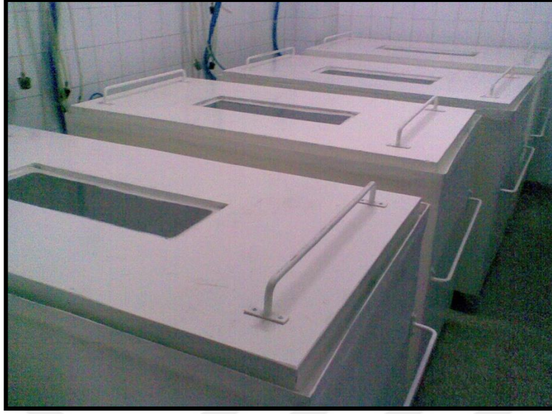
Şekil 3.3. 1-MCP uygulamalarının yapıldığı gaz geçirmez hücreler
