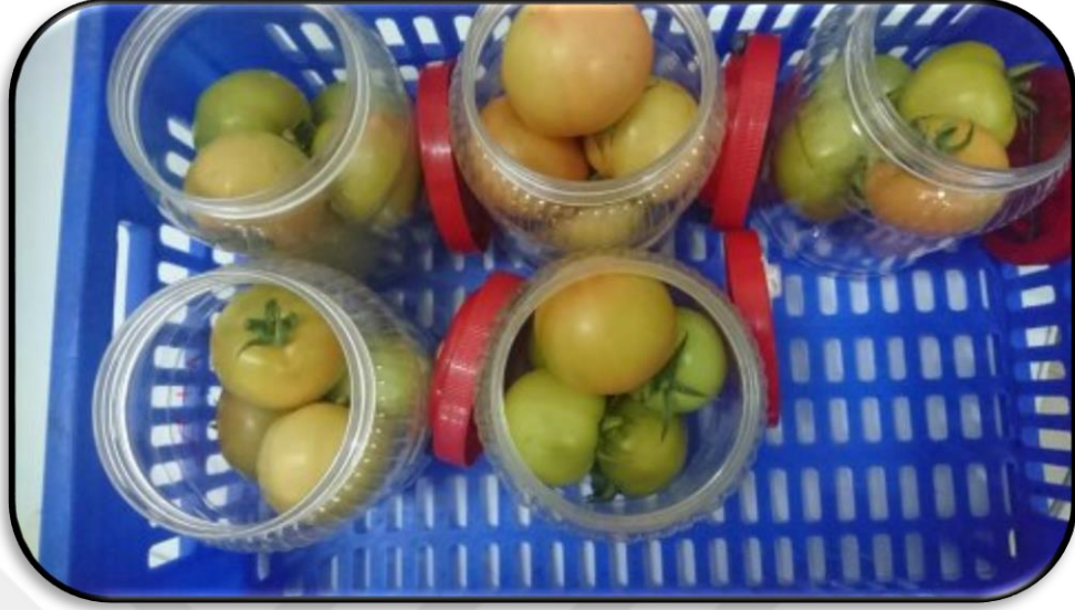
Şekil 3.16. ‘Torry’ domates çeşidinde solunum hızı ve etilen ölçümleri için kullanılan gaz geçirmez kaplar
