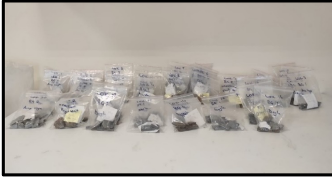
Şekil 3.2. Petrografik incelemeler için hazırlanan örnekler
