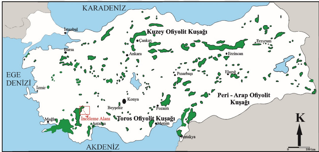
Şekil 2.2. Anadolu levhasında yer alan ofiyolitik birimler (Juteau 1980 ve Güneş 2018'den değiştirilerek alınmıştır. Yeşil renkli alanlar: ofiyolitler)
