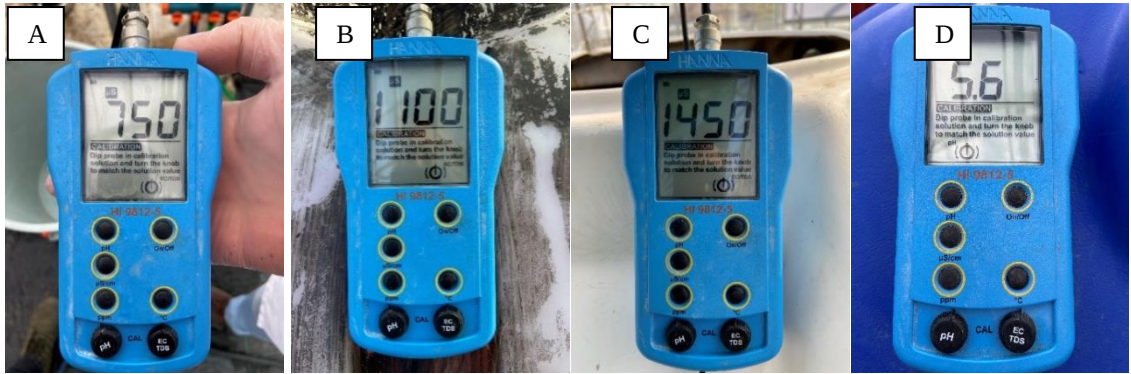
Şekil 3.9. Farklı oranlarda hazırlanan gübrelerin EC seviyeleri ve pH değerleri (A: Kontrol (Çeşme suyu), B: EC 1.1, C: EC 1.45, D: pH 5.6) (Orijinal)
