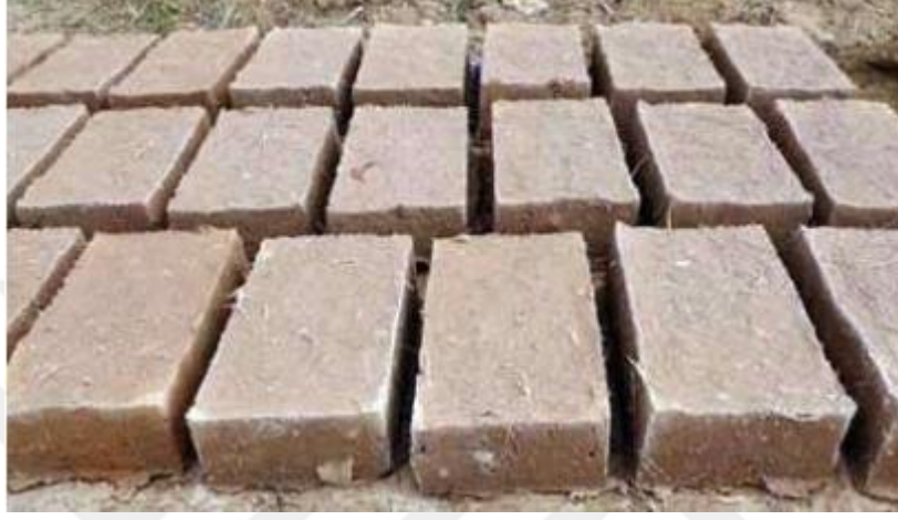
Şekil 2.7. Kalıptan çıkartılmış kerpiç malzemesi
