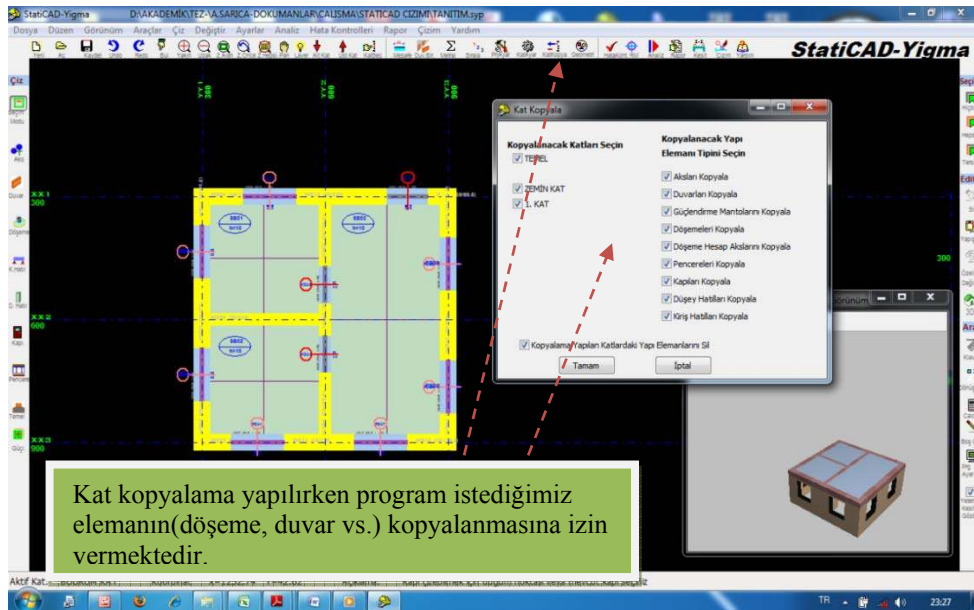
Şekil 4.24. Aynı mimarideki katların kopyalanarak çoğaltılması
