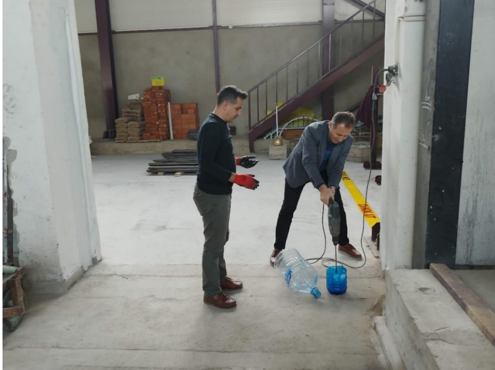
Şekil 2.38. Epoksi reçine karışımının hazırlanması
