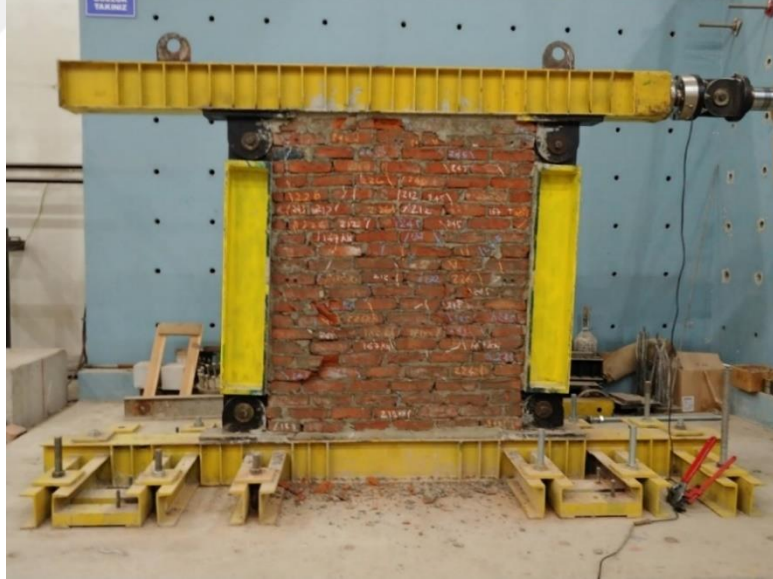
Şekil 2.37. Harman tuğla duvarı çevrimsel yükler altında
