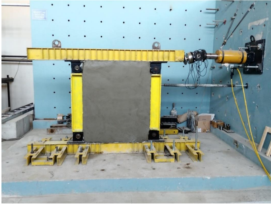
Şekil 2.23. Sıvalı delikli tuğla duvarı
