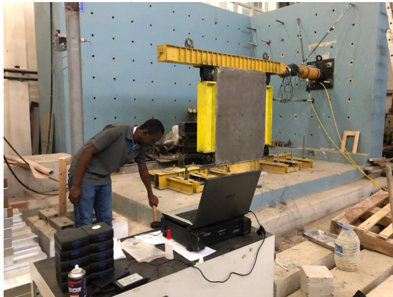
Şekil 2.33. Delikli duvar için çekiçle uyarma
