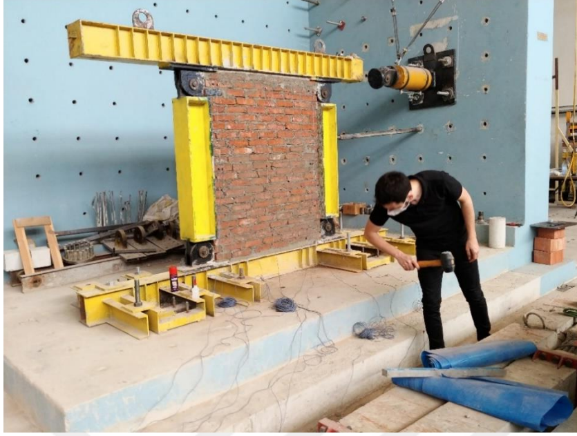
Şekil 2.34. Harman duvar için çekiçle uyarma
