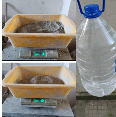
Şekil 2.19. Karıştırmadan önce farklı malzemelerin tartılması
