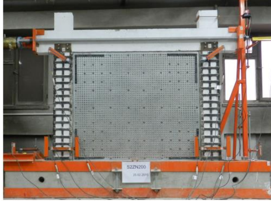
Resim 2.3. Özbek (2015) Yaptığı deney düzeneği ve köşelerde alınan önlemler
