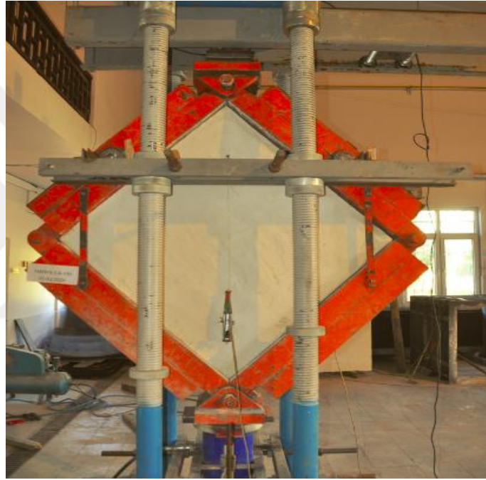
Resim 6.9. MBWS 3,0-150 numunesinin deney önesi durumu
