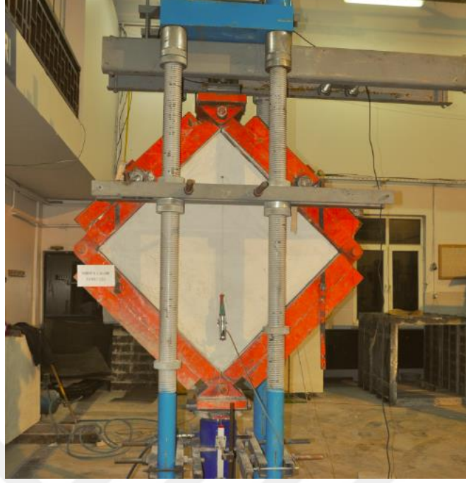
Resim 6.5. MBWS 3,0-400 numunesinin deney öncesi durumu
