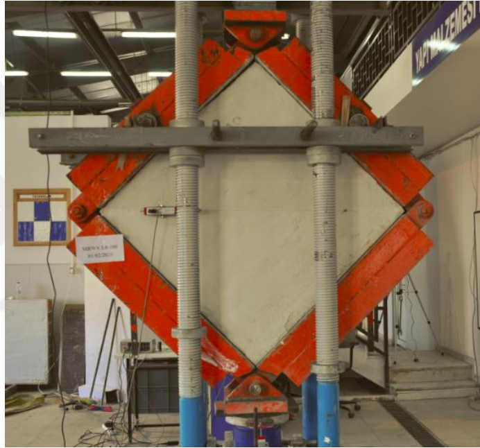
Resim 6.7. MBWS 3,0-200 numunesinin deney öncesi durumu
