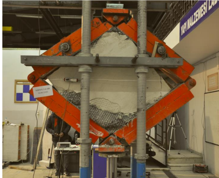
Resim 6.6. MBWS 3,0-400 numunesinin deney sonrası hasar durumu
