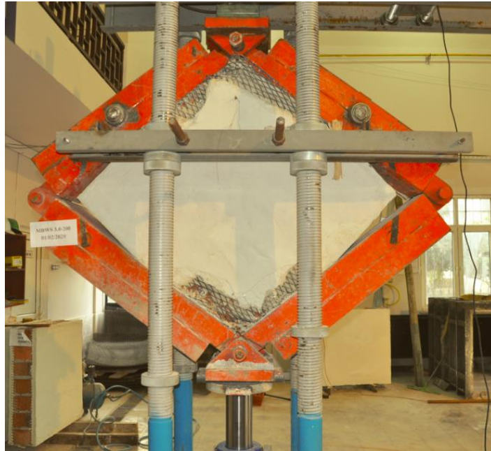
Resim 6.8. MBWS 3,0-200 numunesinin deney sonrası hasar durumu
