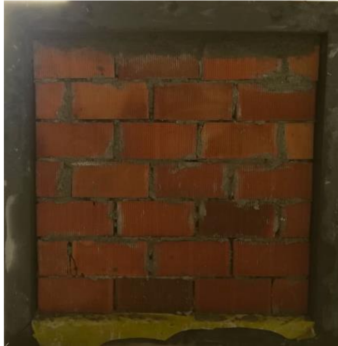
Resim 5.1. Deney elemanının tuğla örülme aşaması
