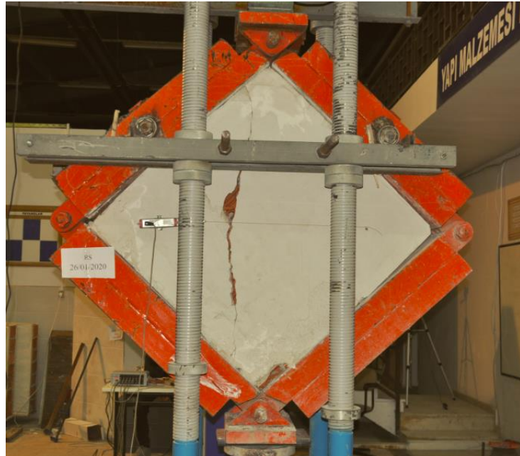
Resim 6.2. RS (Referans deney elemanının) deney sonrası durumu
