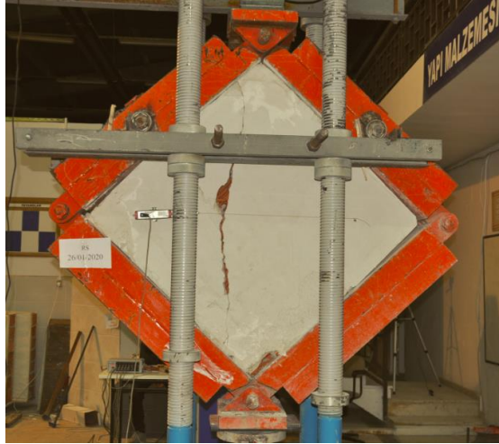
Resim 7.1. Referans deney elemanının deney sonu hasar durumu
