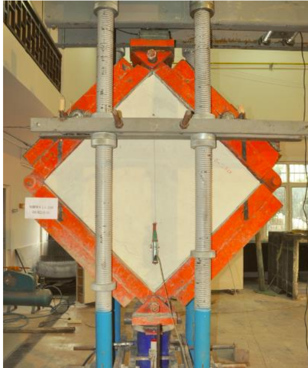
Resim 6.3. MBWS 2,0-200 numunesinin deney öncesi durumu
