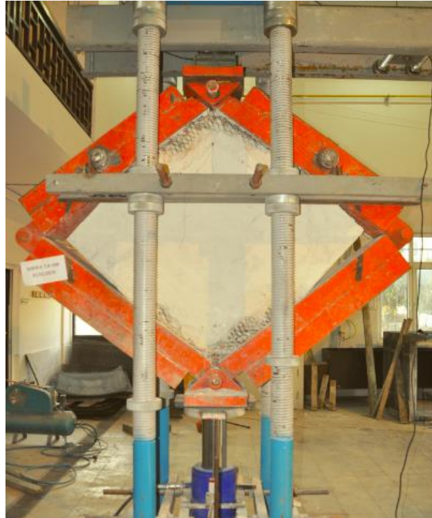
Resim 6.12. MBWS 3,0-100 numunesinin deney sonrası hasar durumu
