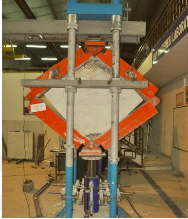
Resim 6.4. MBWS 2,0-200 numunesinin deney sonrası hasar durumu
