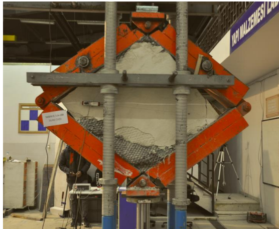
Resim 7.2. MBWS 3,0-400 Güçlendirilmiş deney elemanının deney sonu hasar durumu
