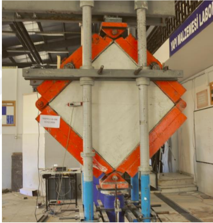
Resim 6.11. MBWS 3,0-100 numunesinin deney öncesi durumu
