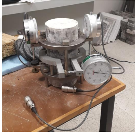
Resim 4.4. Silindir numuneye potansiyometre bağlanma şekli.
