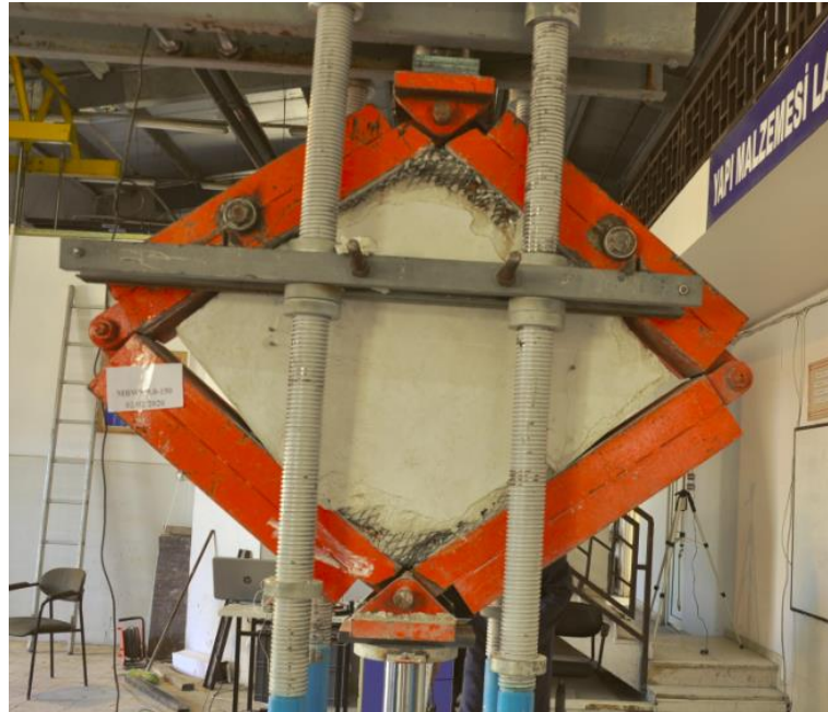
Resim 6.10. MBWS 3,0-150 numunesinin deney sonrası hasar durumu
