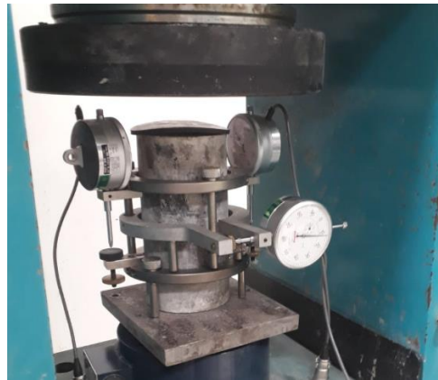
Resim 4.5. Silindir numuneye potansiyometre bağlanarak dayanım ve deformasyon testi.
