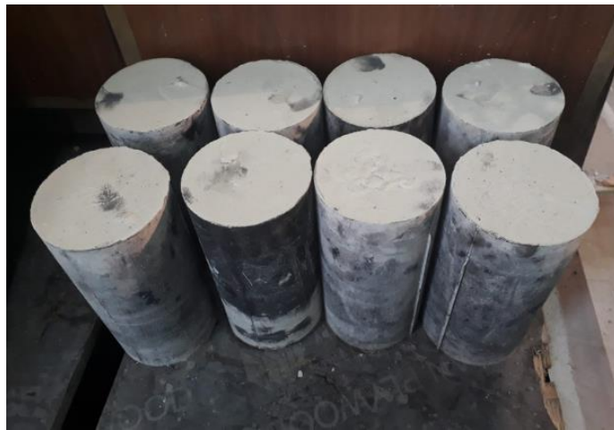
Resim 4.2. Püskürtme beton silindir numuneler.
