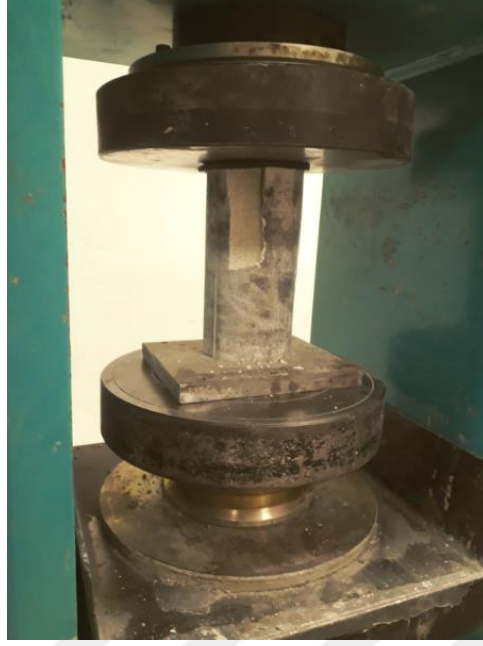
Resim 4.3. Püskürtme beton silindir numune test anı.
