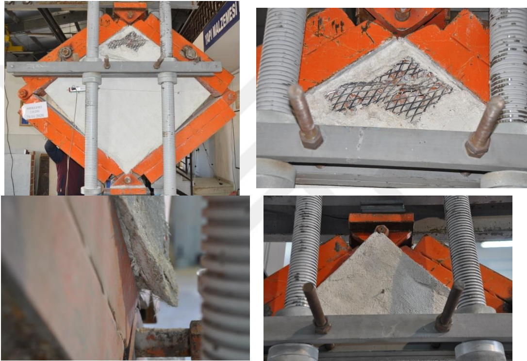
Şekil 6.15. MBWGFR 2.0mm-200mm elemanın deneyden sonra hasar durumu
