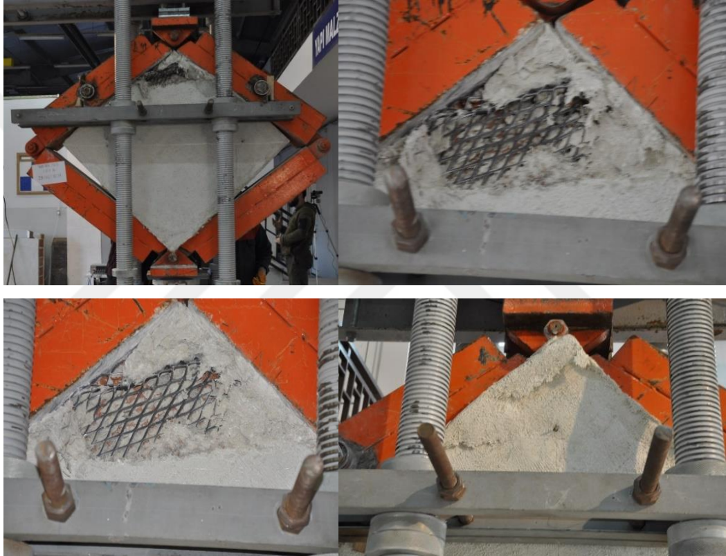
Şekil 6.18. MBWGFR 3.0mm-150mm elemanın deney sonrası hasar durumu
