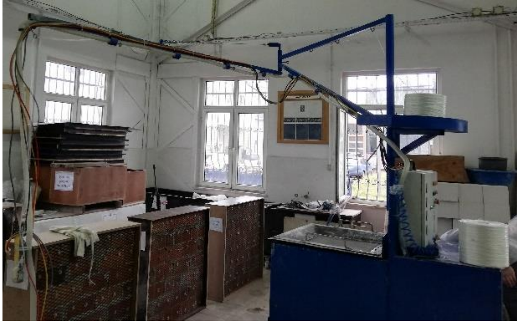
Şekil 5.2. Püskürtme beton uygulama düzeneği
