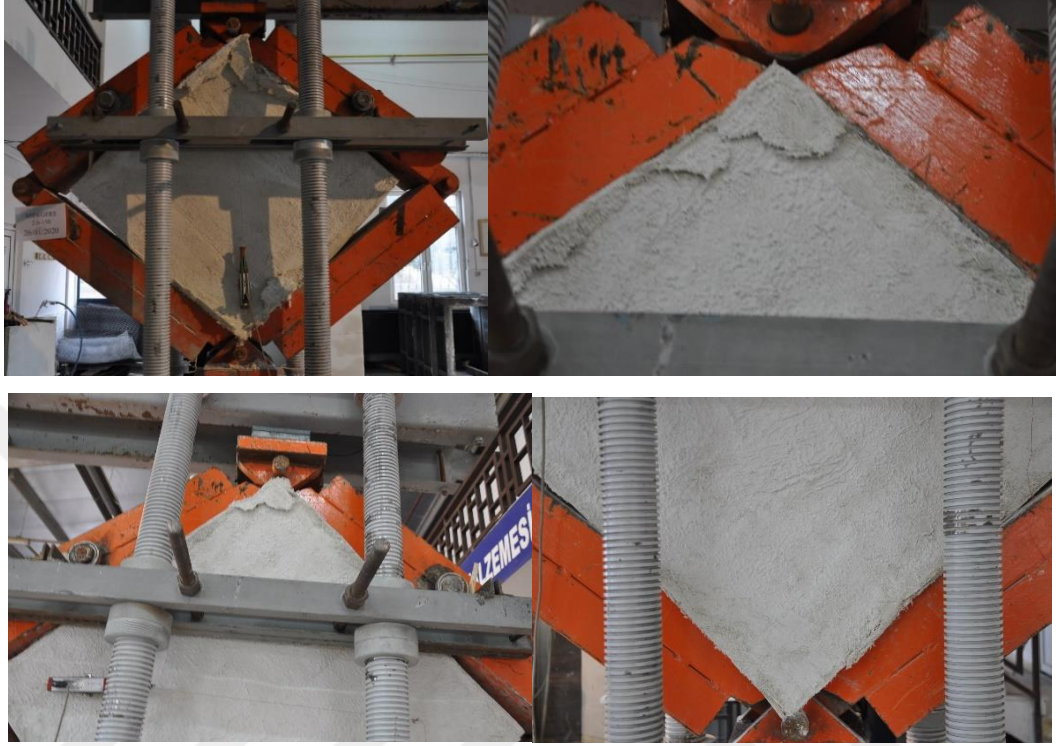
Şekil 6.12. MBWGFR 2.0mm-150mm elemanın deney sonrası hasar durumu
