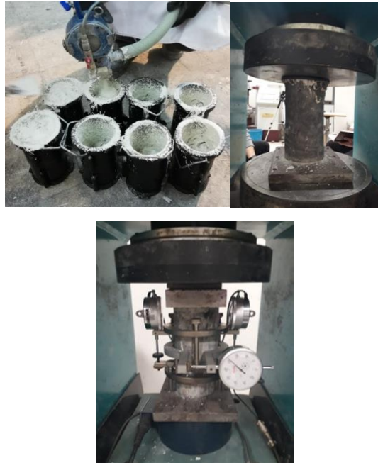
Şekil 5.4. Cam lif katkılı püskürtme beton silindir numuneleri ve basınç deneyi
