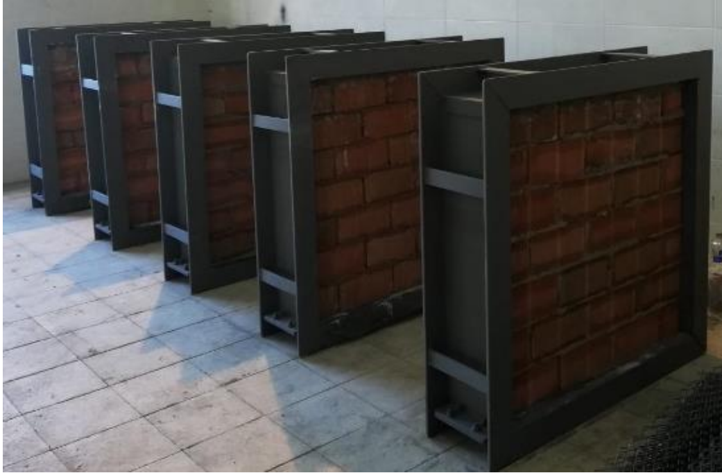
Şekil 4.9. Güçlendirmeden önce deney elemanları
