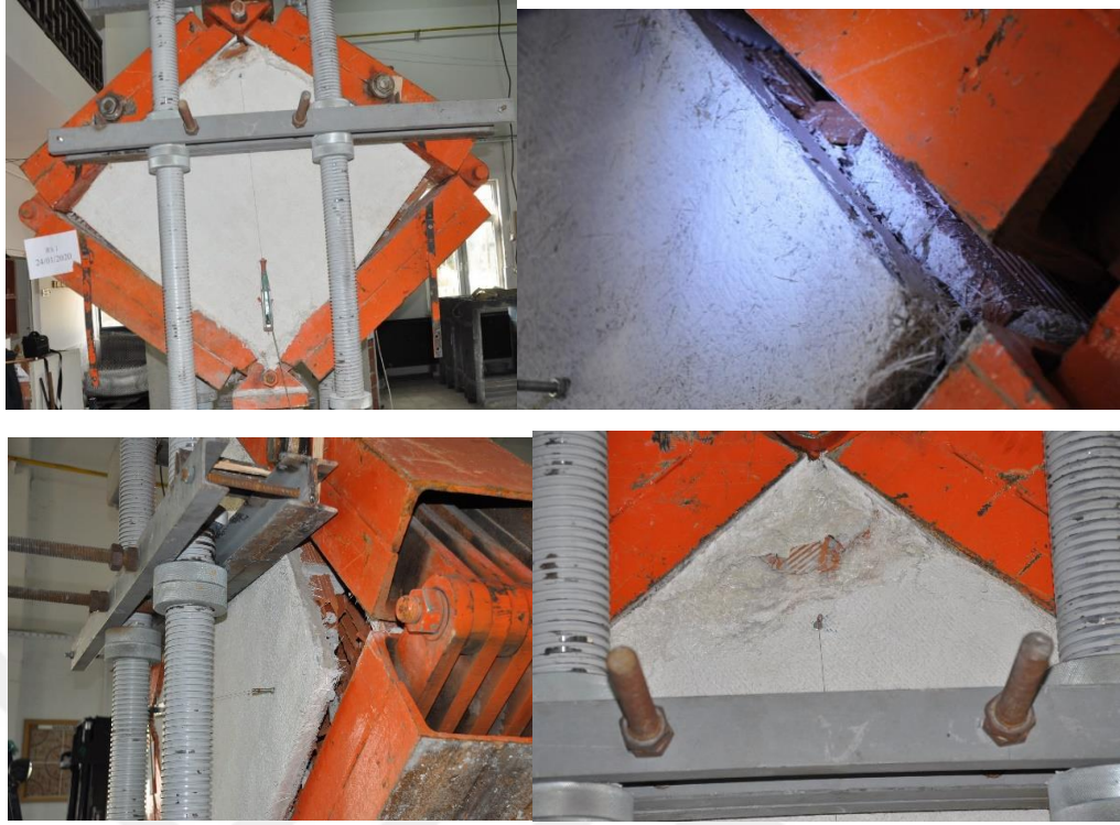
Şekil 6.6. RGFR elemanın deney sonrası hasar durumu
