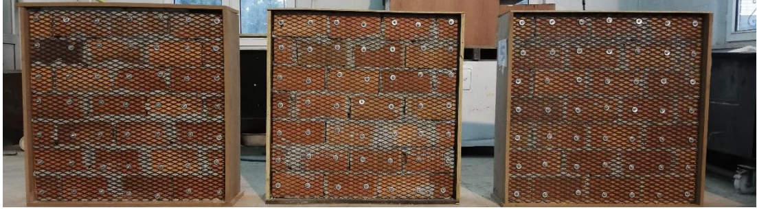
Şekil 4.17. Genişletilmiş çelik levha ile güçlendirilmiş deney elemanları.
