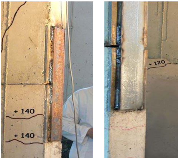
Resim 4.16. 255 kN yük altındaki çelik plakanın görüntüsü
