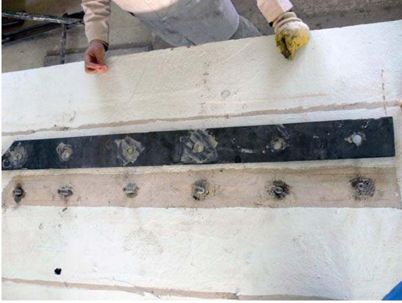
Resim 4.7. Deney sonrası bağlantı çubuklarının görünümü
