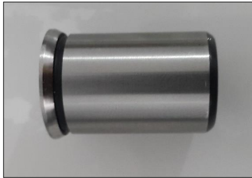
Şekil 5.20. Namlu fişek yatağı uskurya mastarı.
