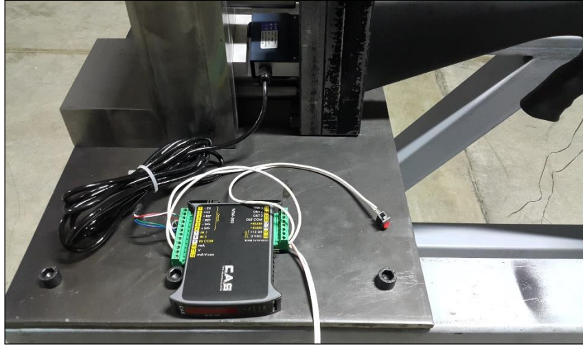
Şekil 5.27. Yük hücresi ve ağırlık vericisinin sistem üzerinde görünümü.
