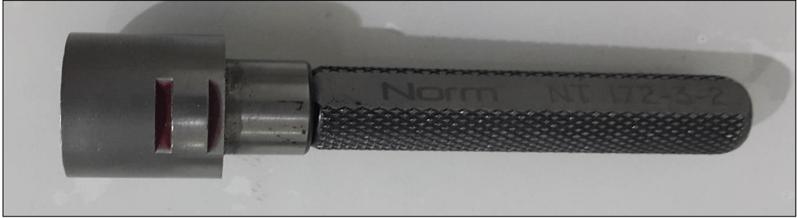
Şekil 5.19. Namlu fişek yatağı ağız çapı kontrol mastarı(geçer-geçmez).
