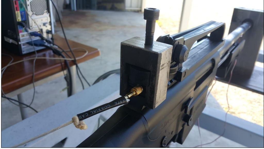
Şekil 5.30. İvme sensörünün sistem üzerinde görünümü.
