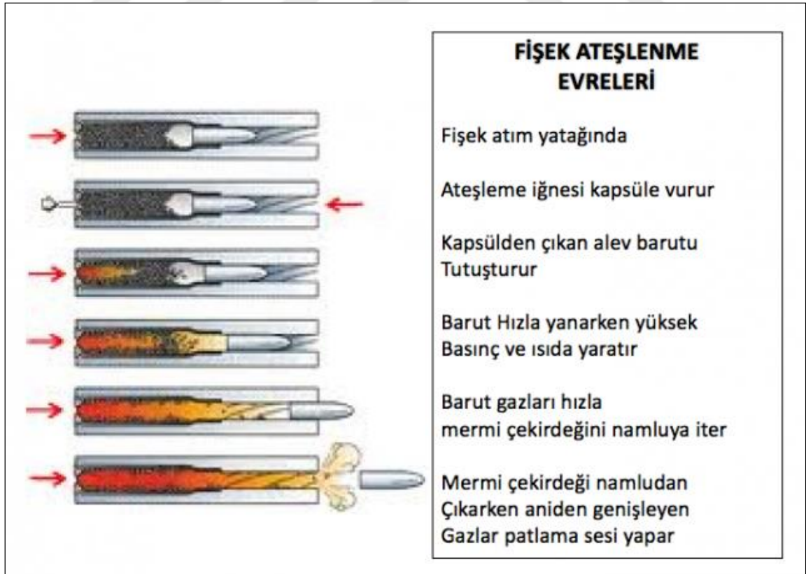
Şekil 3.20. Av fişeginin ateşleme evreleri.
