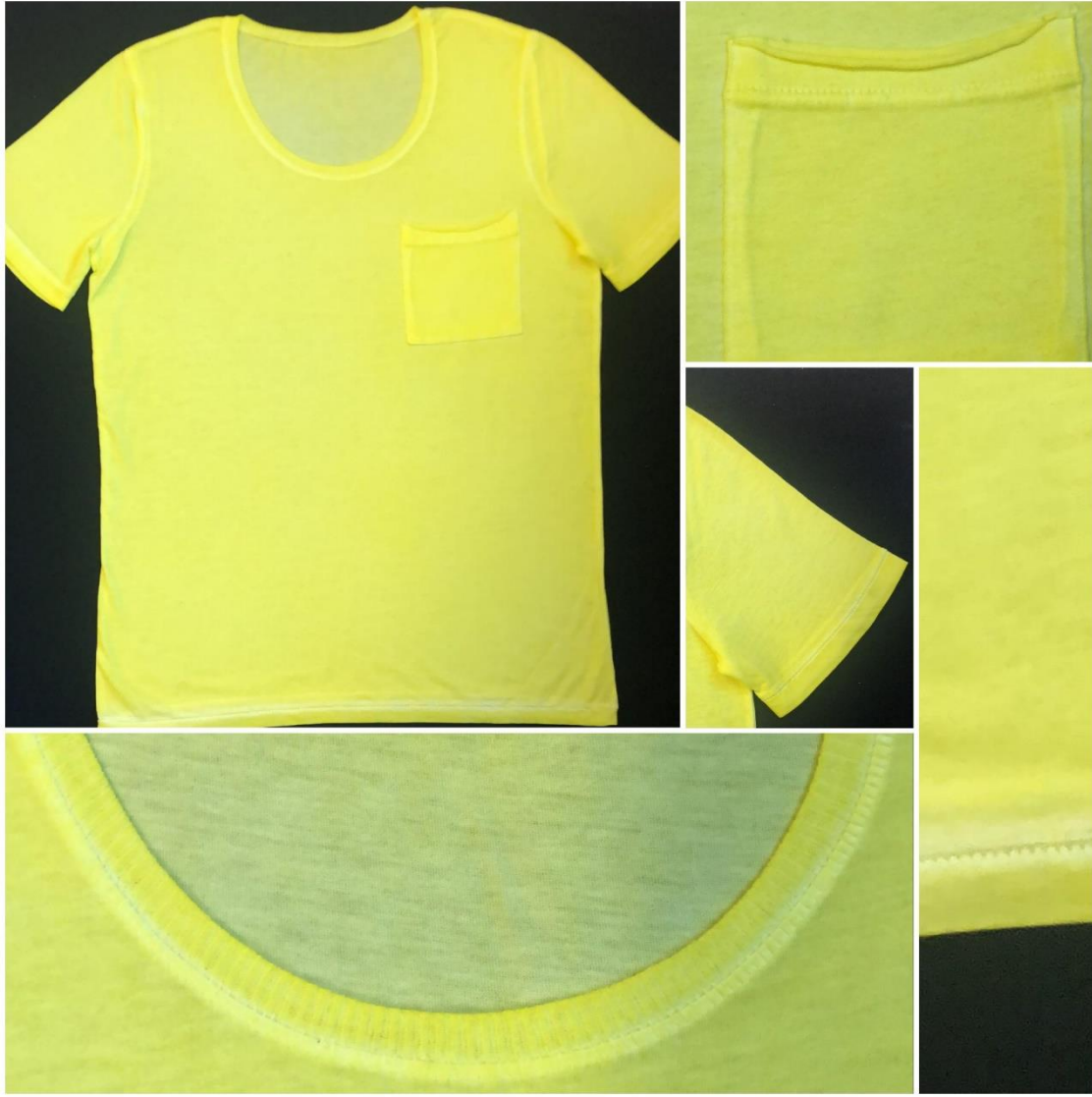
Şekil 2.45: Açık renk dıştan yağ yıkama sonrası 1g numunesi genel görünüm ve detay görselleri
