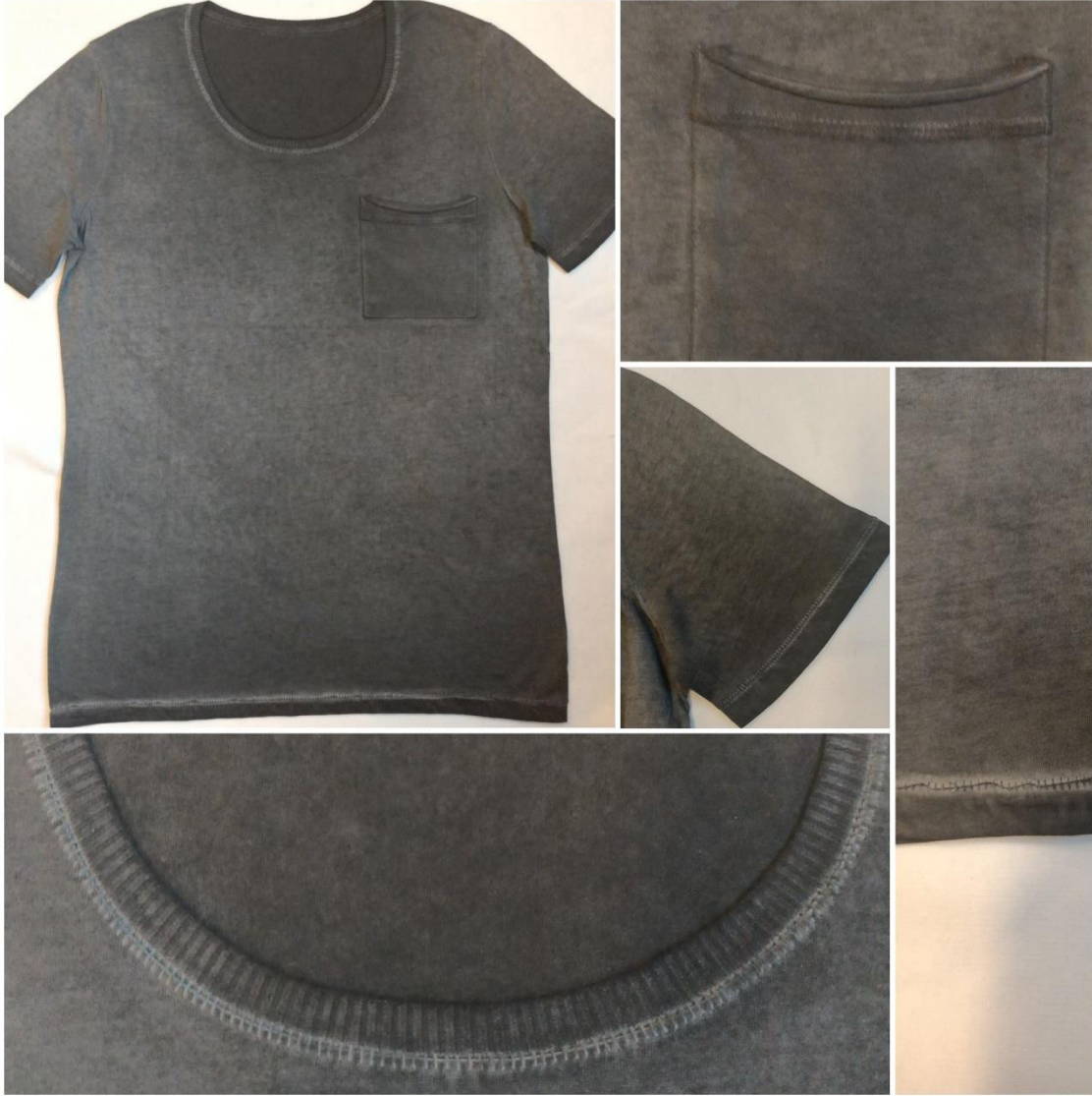
Şekil 2.41: Koyu renk içten yağ yıkama sonrası 1c 1 numunesi genel görünüm ve detay görselleri
