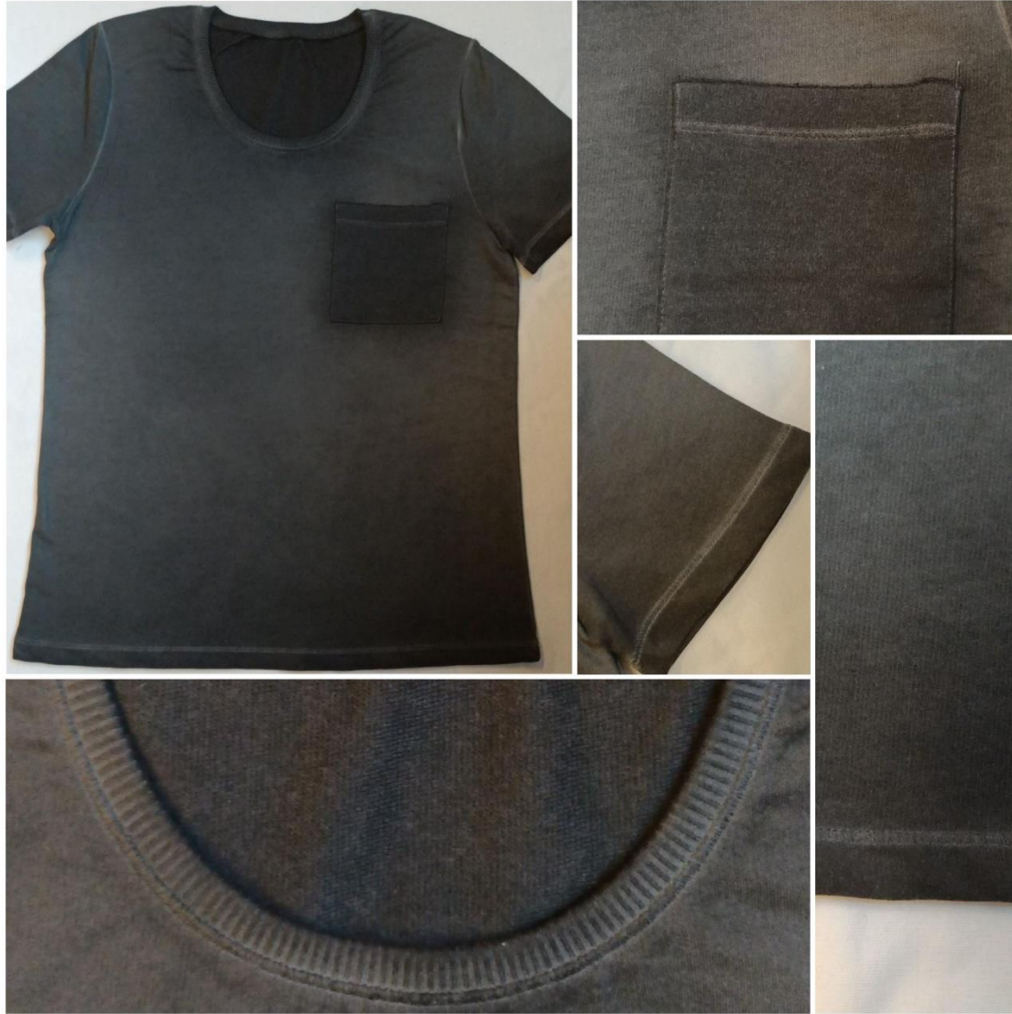
Şekil 2.39: Koyu renk içten yağ yıkama sonrası 1a 1 numunesi genel görünüm ve detay görselleri
