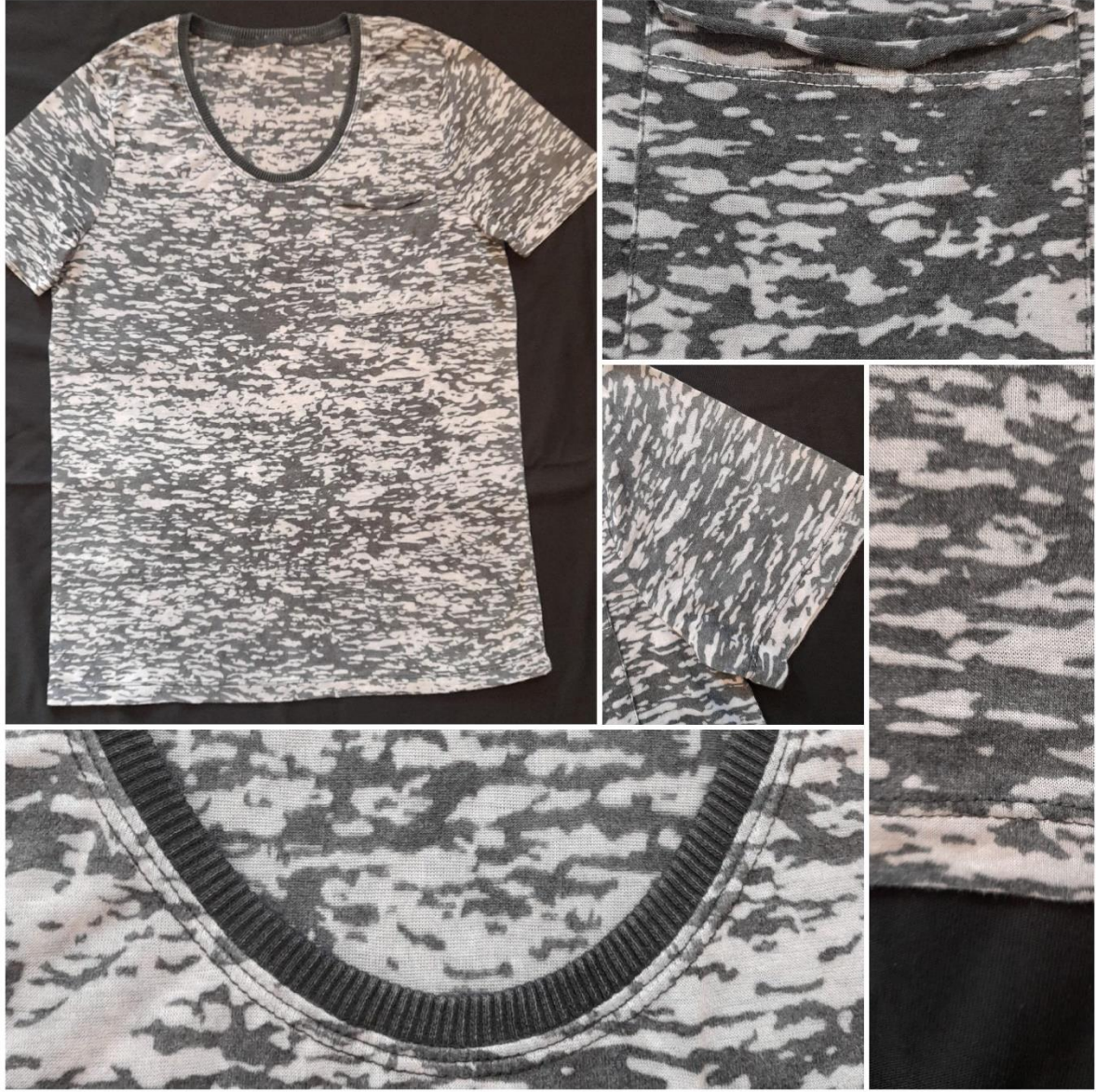
Şekil 2.74: Koyu renk asit yıkama sonrası 3d 1 numunesi genel görünüm ve detay görselleri
