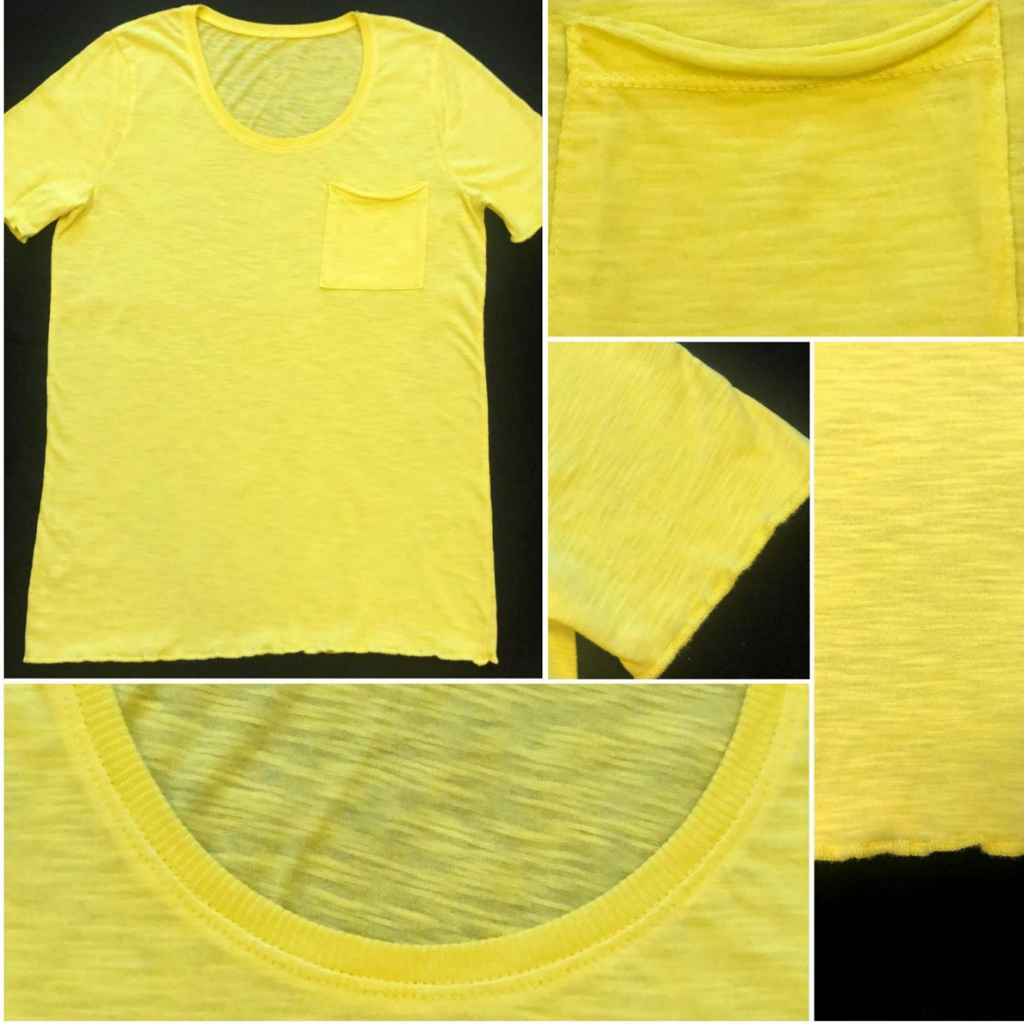
Şekil 2.68: Açık renk asit yıkama sonrası 3b numunesi genel görünüm ve detay görselleri
