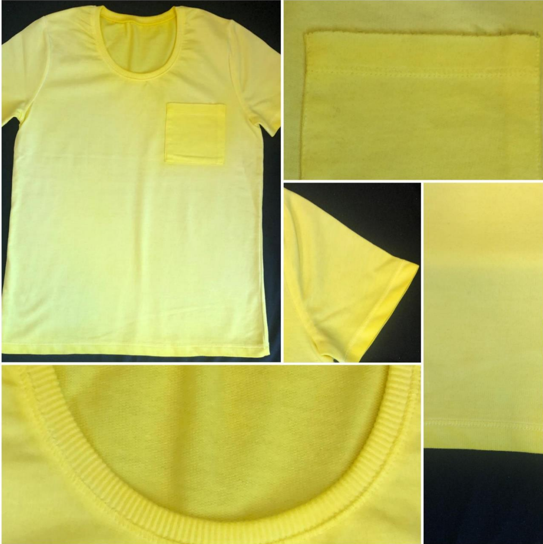
Şekil 2.35: Açık renk içten yağ yıkama sonrası 1a numunesi genel görünüm ve detay görselleri
