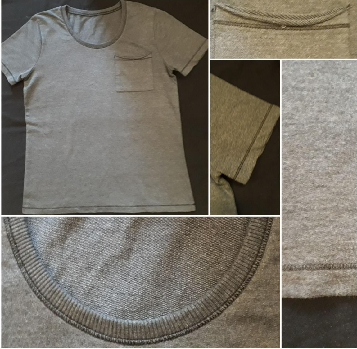
Şekil 2.71: Koyu renk asit yıkama sonrası 3a 1 numunesi genel görünüm ve detay görselleri
