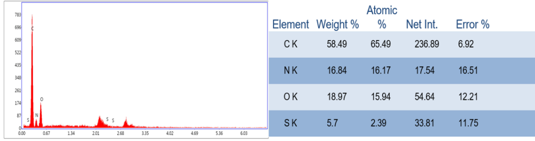
Şekil 4.17. Mentese iç kısım EDX analizi.
