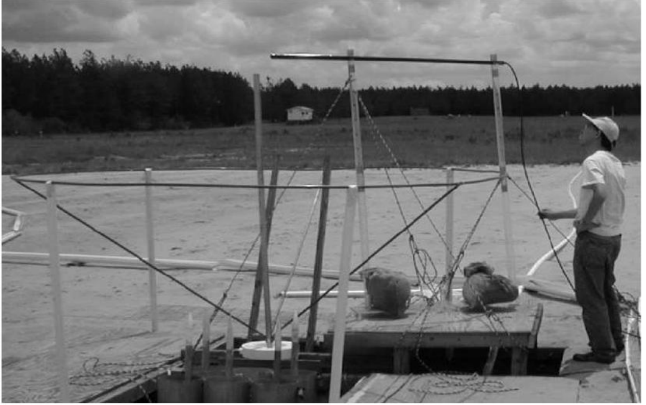
Şekil 2.14. Pockels sensor yardımıyla yıldırımın enerji ve güç ölçümü [25].
