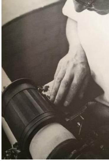
Görsel 6: Wedgwood Fabrikalarında Uygulanan Yatay Eksenli Torna Dekoru.
