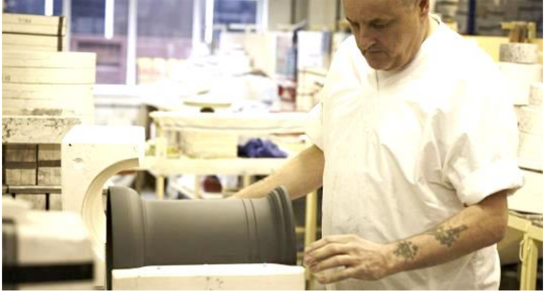
Görsel 92: Wedgwood Fabrikalarında Uygulanan Alçı Kalıba Döküm ile Şekillendirme Yöntemi.
