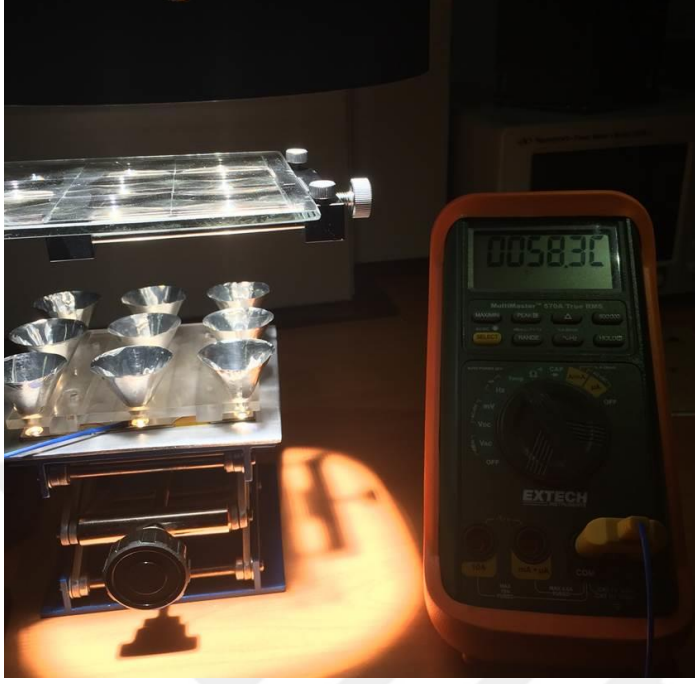
Şekil 4.9. Al plakalı hücre alıcı sistemin, hücre yakınlarında üst Cu yüzeyin sıcaklığı
