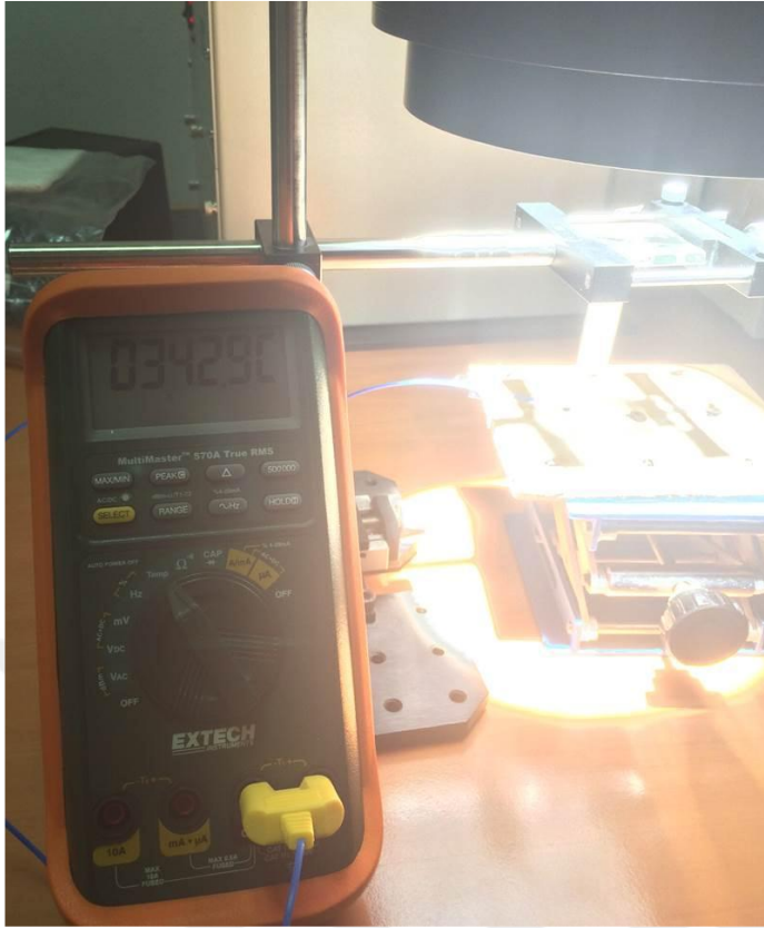
Şekil 4.5. Fresnel merceğin odak uzaklığındaki yoğunlaştırma sıcaklığı
