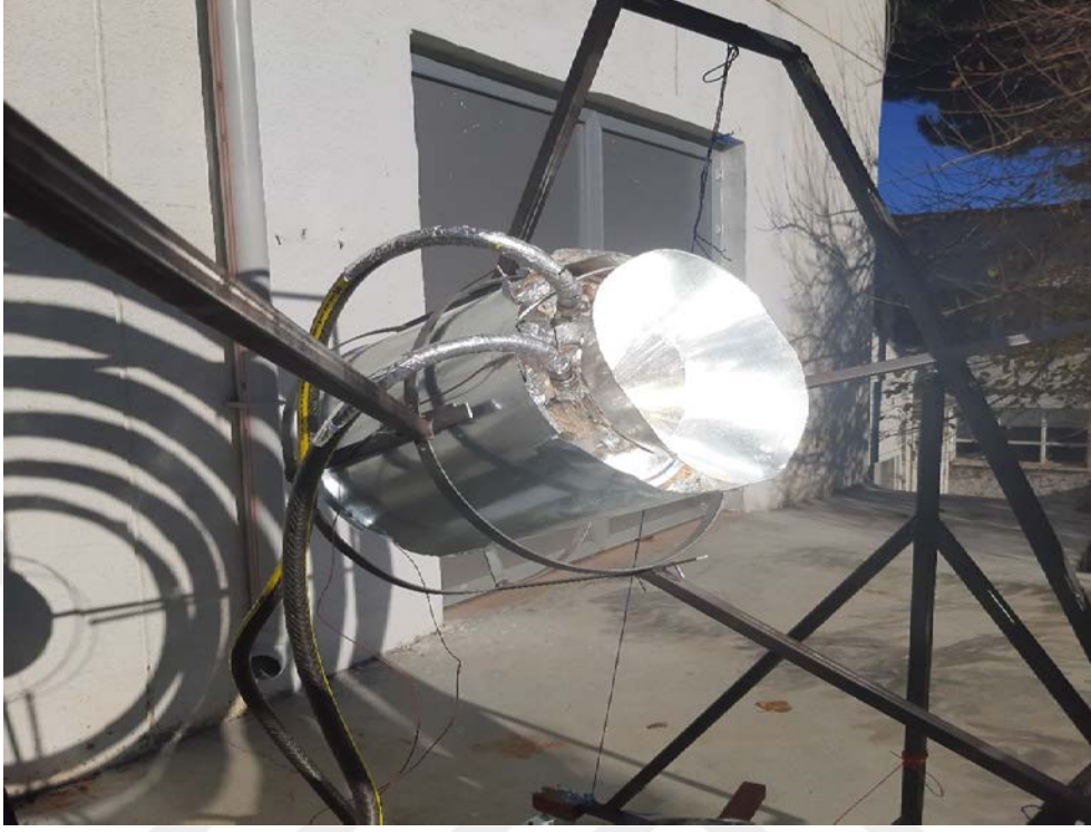
Ek Şekil 3. Halka dizisi yoğunlaştırıcı odağına yerleştirilen fırının bir fotoğrafı
