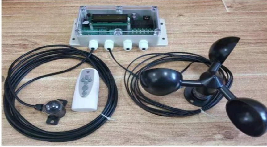
Şekil 10. Güneş takip sistemi kontrolörü, ışın sensörü ve rüzgâr ölçüm cihazı
