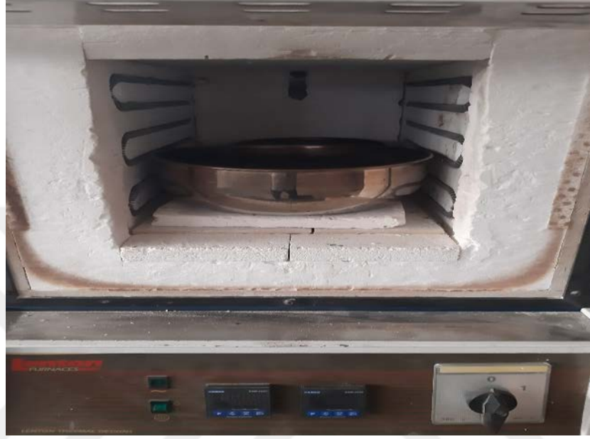
Ek Şekil 1. Solar ve Hitec tuzlarının hazırlanmasında kullanılan elektrikli fırın
