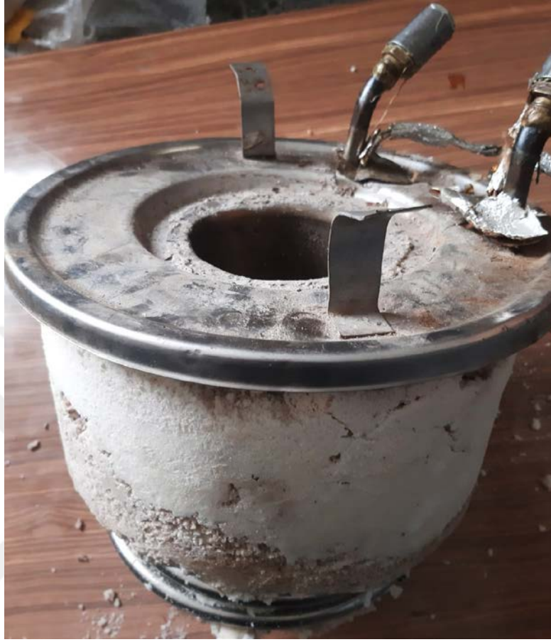
Ek Şekil 13. 27 Eylül 2023'te yapılan deneydeki fırın kabından çıkarılan eriyen Hitec tuzunun görüntüsü
