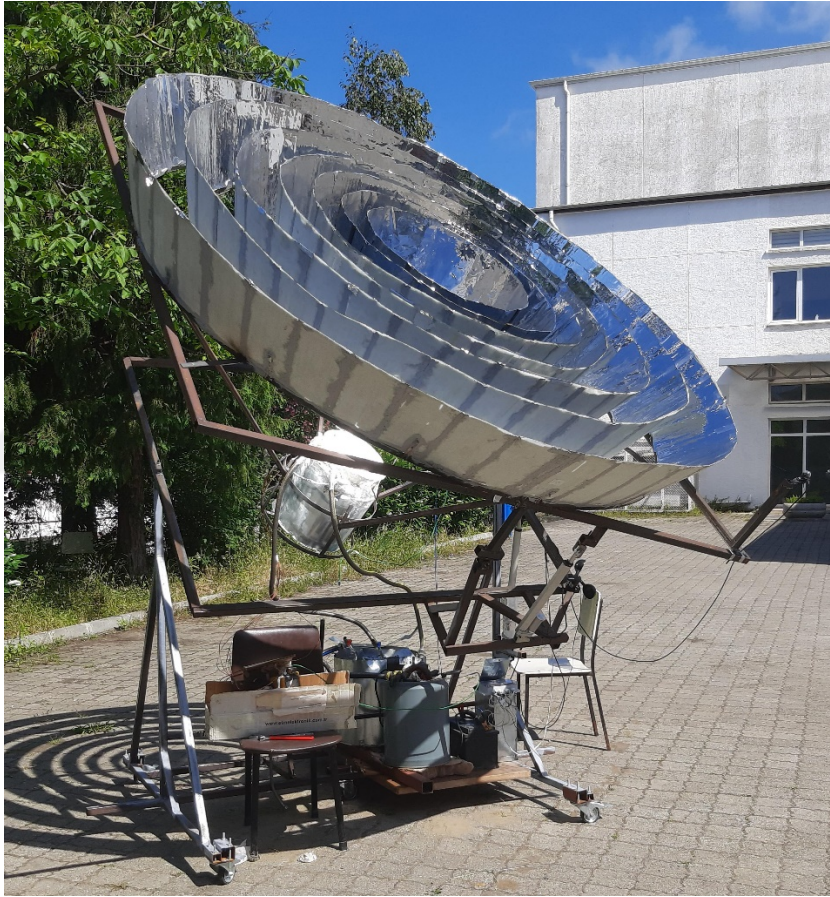
Şekil 12. Deney anındaki HDY2 ile ısı depolama sisteminin genel görüntüsü
