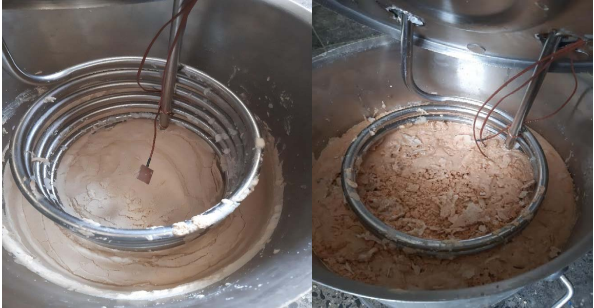
Ek Şekil 2. Isı depolama tankındaki FDM2'nin ve termoelemanların yerleştirilmesine ait görüntüler; solda orta noktada, sağda üst noktada termoeleman yerleşimi
