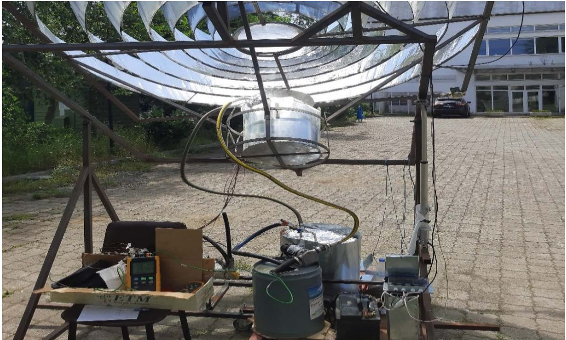
Ek Şekil 12. Haziran ayında fırın ve ısı depolama tankı bağlantısına ait bir görüntüsü
