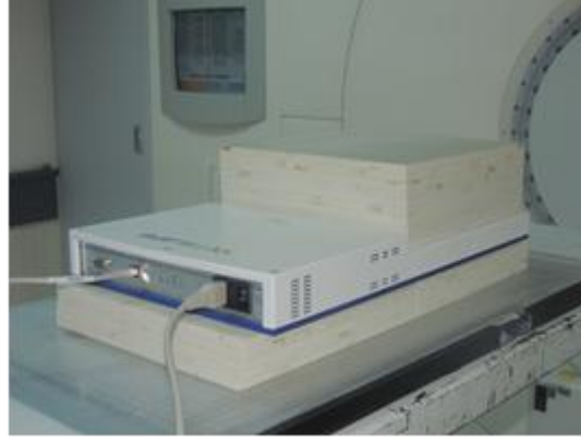
Resim 3.9 İki Boyutlu İyon Odası ile Ölçüm Düzeneği
