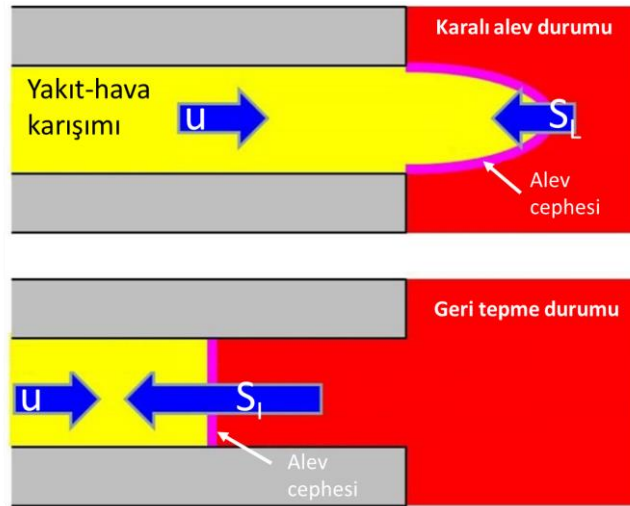
Şekil 2.7. Yakıt ve yakıcı karışımın akış hızı u ve laminer alev hızı S_L [11].
