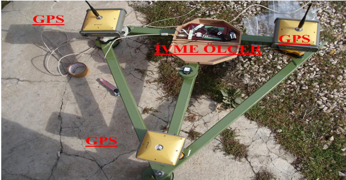
Resim 3.1: GPS ve İvmeölçerin yerleştirildiği düzenek
