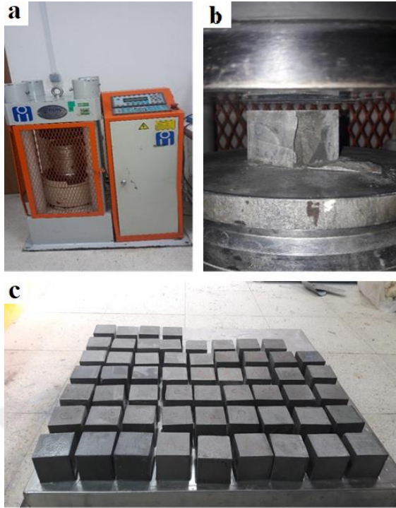
Şekil 3.6. Basınç deneyi; a) Kullanılan pres makinesi; b) Numune kırıldıktan sonra; c) 50 mm küp numuneler
