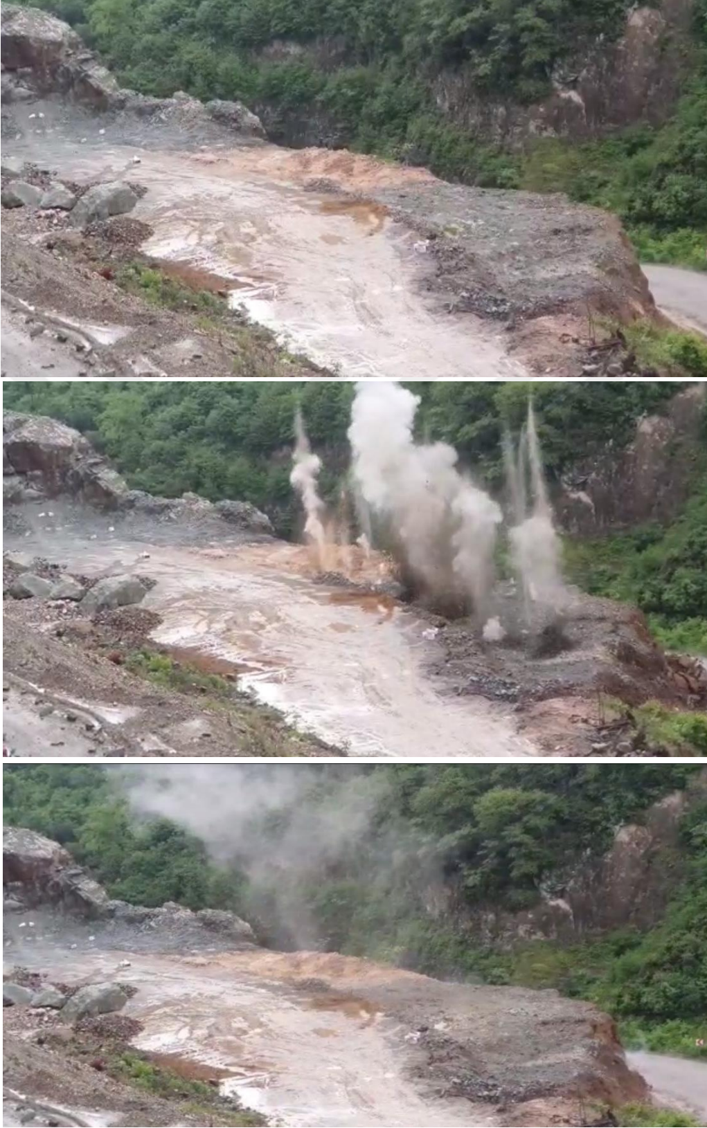
Şekil 45. Kaya kırıcı kartuş ile yapılan 2.deneme patlatmasının zamana bağlı görünümü (tüm fotoğraflar patlatma anından itibaren toplam 5 sn içerisinde alınmıştır)
