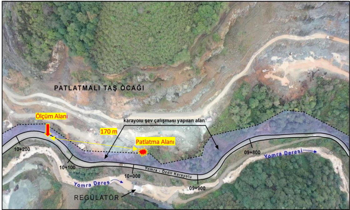
Şekil 47. Patlatma ve ölçüm noktalarının görünümü
