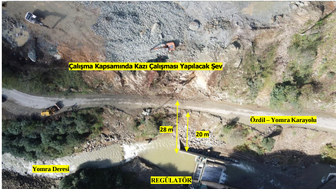
Şekil 35. Yomra Deresi üzerinden bulunan regülatörün Yomra-Özdil karayoluna ve kazı çalışması yapılacak şeve göre konumu
