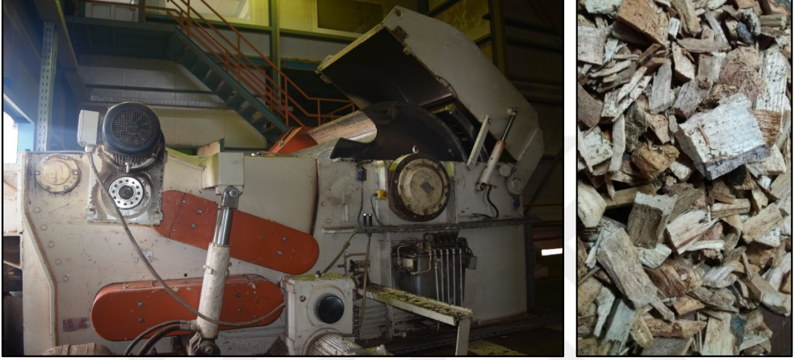
Şekil 12: Chipper (Yongalayıcı) ve yonga (Fotoğraf: Ufuk AYDIN 2016).
